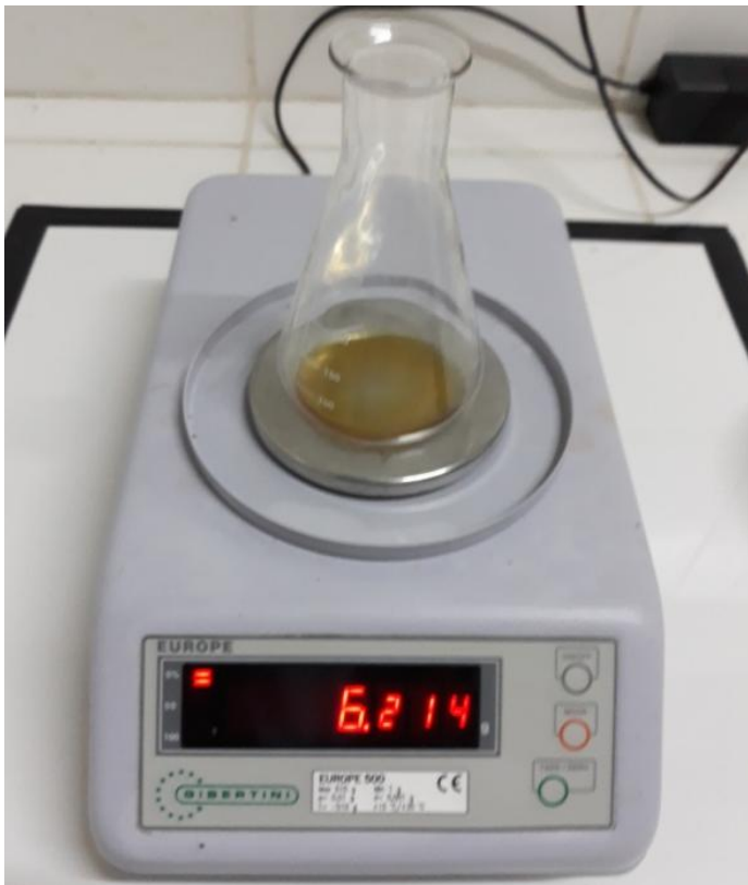
Foto 11.- Pesado de muestra para determinar índice de acidez
