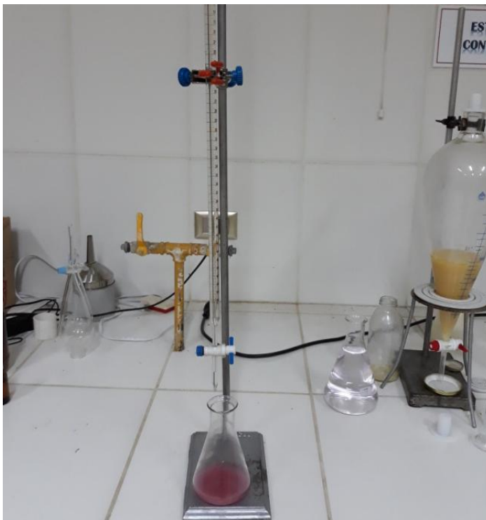
Foto 12.- Titulación de muestra de biodiesel
