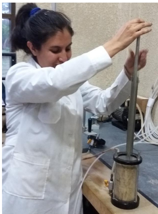
Colocando la arcilla al permeámetro.
