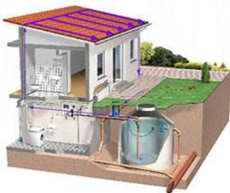
Figura 148: Recolección de aguas pluviales
