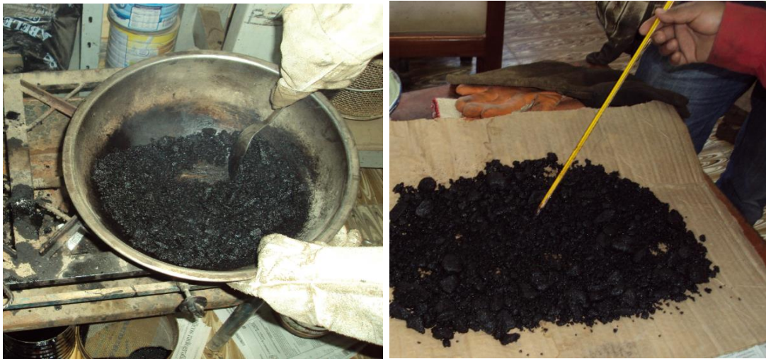
FIGURA 4. 3 PROCESO DE MEZCLADO 160° C Y ENFRIADO HASTA 135° C
