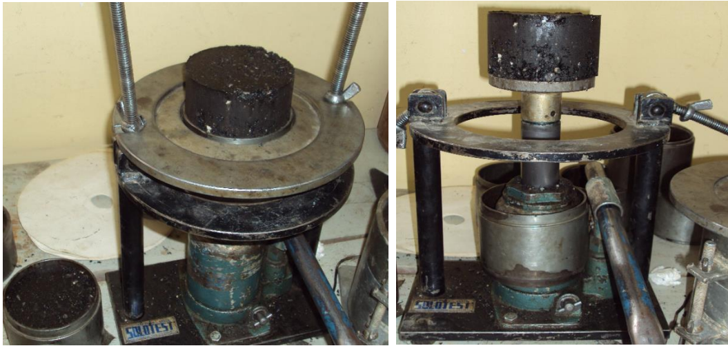
FIGURA 4. 5 DESMOLDADO DE LA BRIQUETA
