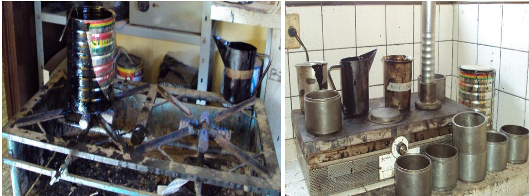
FIGURA 4. 1 CALENTADO DE LA MUESTRA Y DE LOS MOLDES
