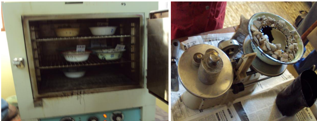
FIGURA 4. 2 CALENTADO DEL AGREGADO Y PESADA DE LA MEZCLA
