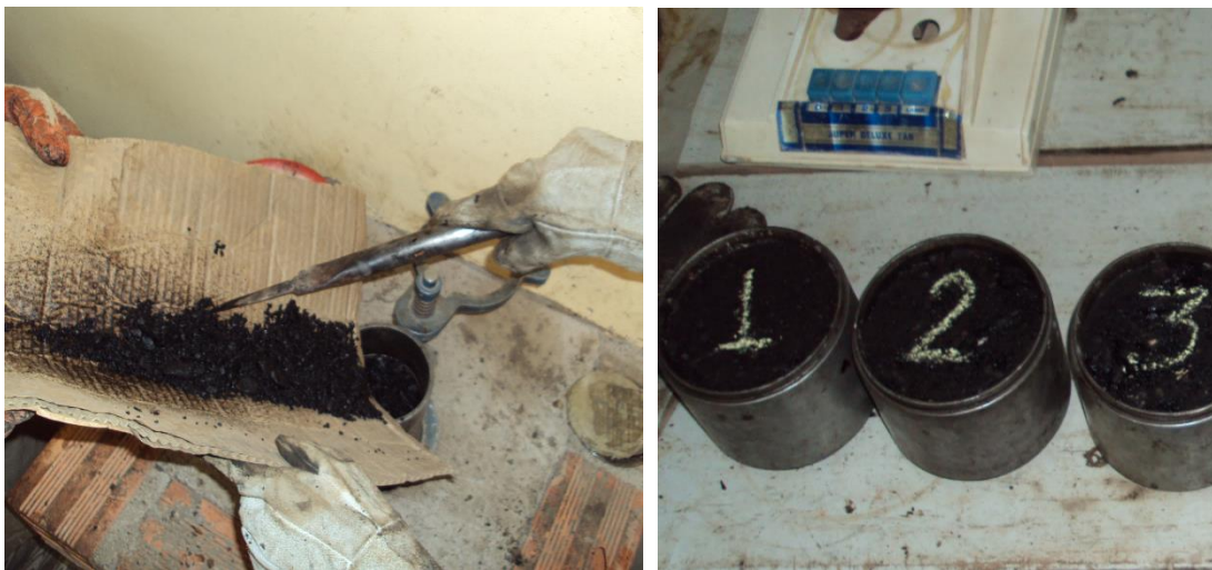
FIGURA 4. 4 VACIADO AL MOLDE PARA COMPACTAR Y BRIQUETAS COMPACTADAS
