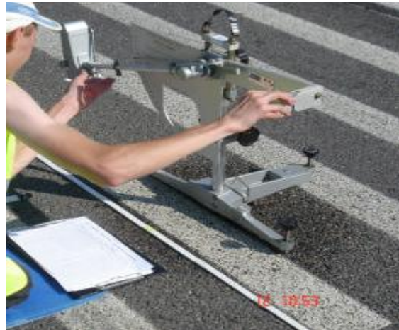
FIGURA 3.5.3-5 EJEMPLO DE ENSAYO DE RUGOSIDAD
