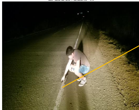
FIGURA 4.3-3 MEDICIÓN DE RETROREFLEXION CARRETERA A BERMEJO
