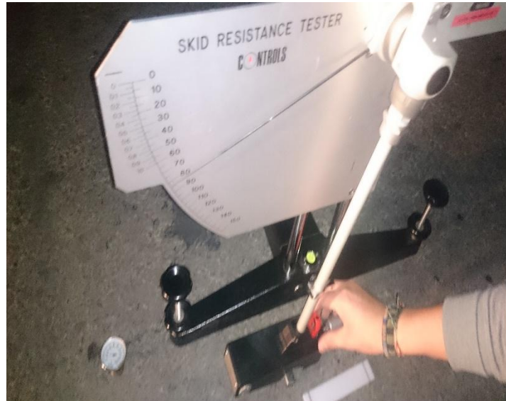
FIGURA 4.3-17 OBTENCIÓN DE DATOS-PÉNDULO DE FRICCIÓN
