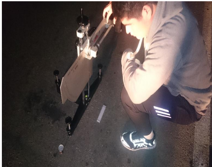
FIGURA 4.3-15 ENSAYO PÉNDULO DE FRICCIÓN
