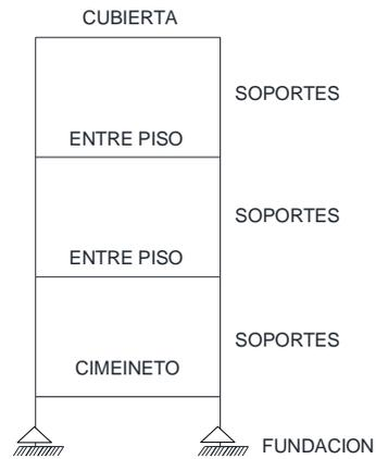
Fig. 3.4.2. Planteo estructural de la estructura Aporticada.
