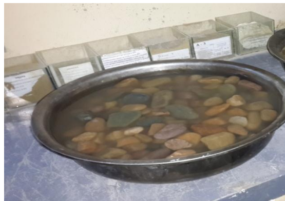
Figura 3.2 Lavado del agregado grueso (grava)
