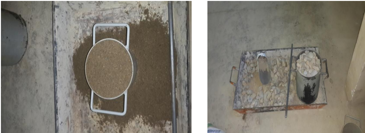
Figura 3.18 Peso unitario suelto de agregados
