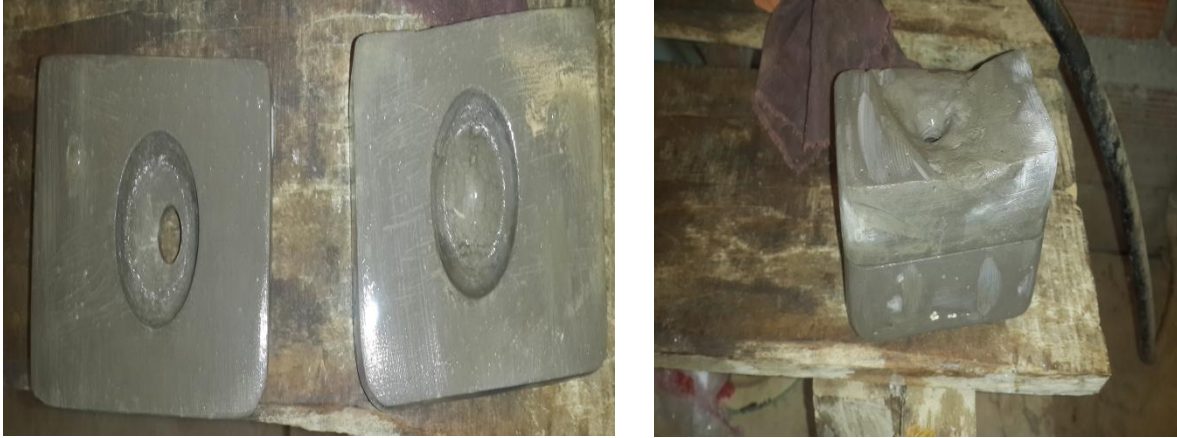
Figura 3.10 Moldes de cemento terminados
