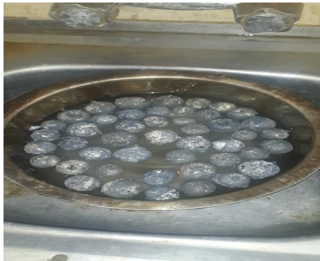
Figura 3.27 Agregado PEBD flotando en el agua
