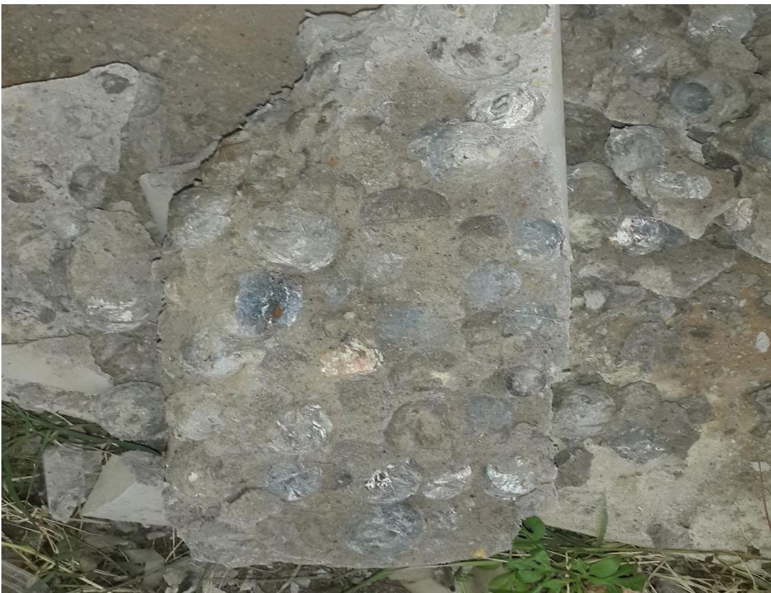
Figura 3.37 probeta rota para verificar la distribución del agregado PEBD
