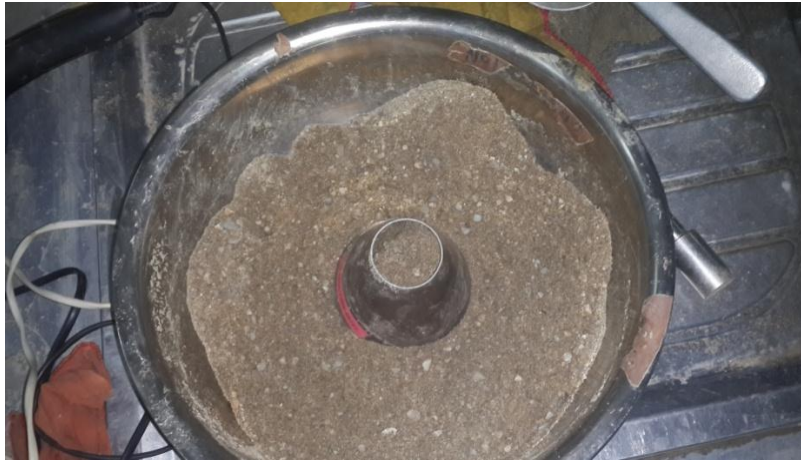
Figura 3.22 prueba del cono en el agregado fino
