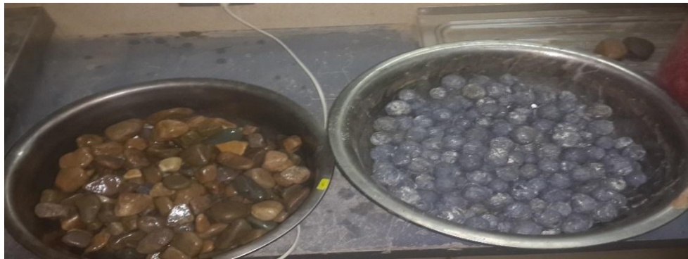
Figura 3.28 reemplazo del agregado grueso por agregado PEBD (volumétricamente)
