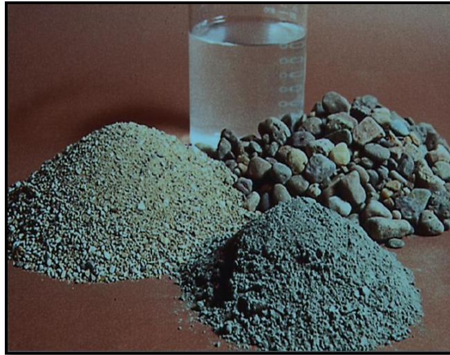
Figura 2.7.1. Componentes de HCR
