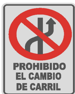
SR-12 PROHIBIDO EL CAMBIO DE CARRIL
