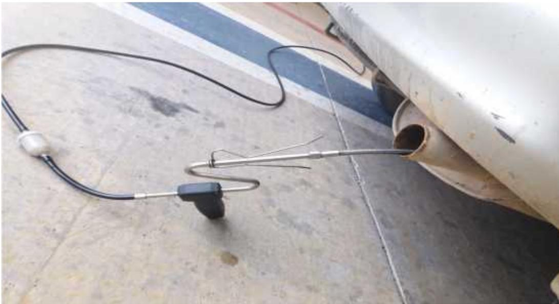
**b) Funcionamiento del MDO2-LON:** Este equipo evalúa la expulsión de gases en vehículos a diesel, en este caso hablamos de la opacidad de los gases que de igual manera que el MGT5 mide a través de una manguera con sensor que va al escape de la movilidad, expulsando como resultado en la computadora un porcentaje de opacidad único.
