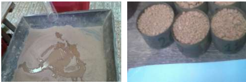
Imagen 3.24: Preparación de Suelo-Cemento para CBR y muestras para Contenido de Humedad
