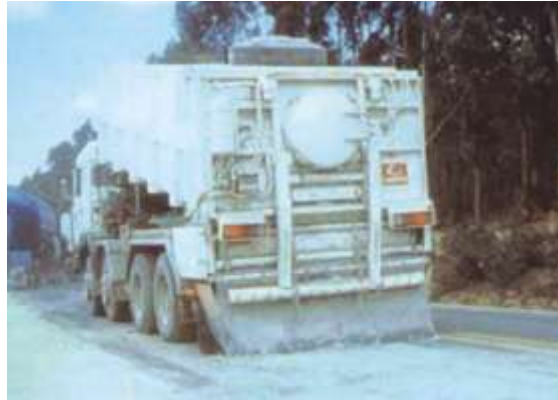
Figura 2.14: Camión distribuidor de cemento
