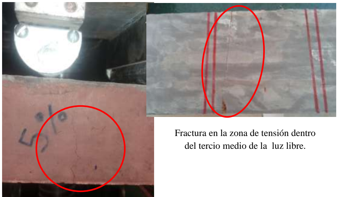
Imagen 3.29. Primera Falla y Fractura en la viga
