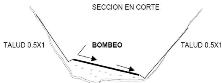
FIGURA N° 5. BOMBEO EN CURVA
