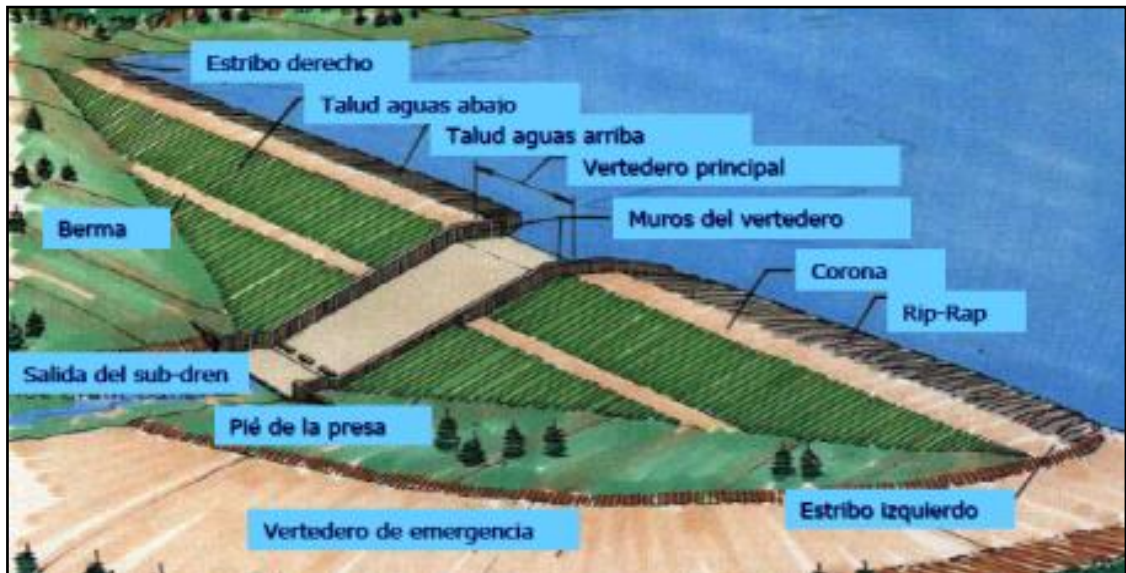
FIGURA4.4 PARTES DE UNA PRESA DE TIERRA
