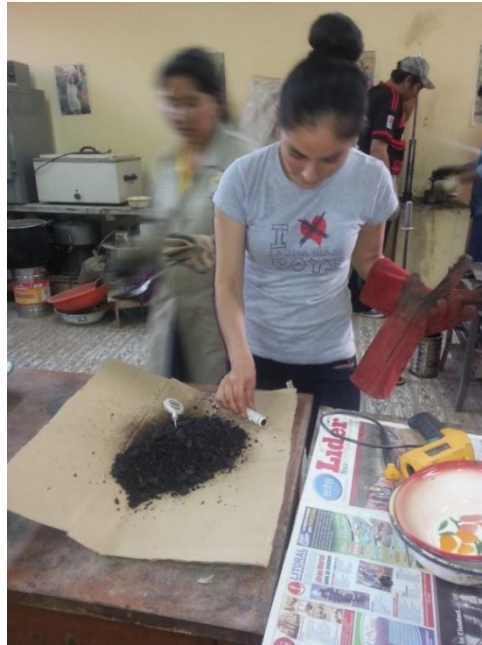
Figura 3.35. Compactación con martillo con 75 golpes por cara
