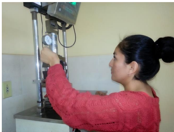
Figura 3.42. Hacer correr y leyendo el dial de Estabilidad (dentro del anillo Marshall) y el dial de deformación para el Flujo
