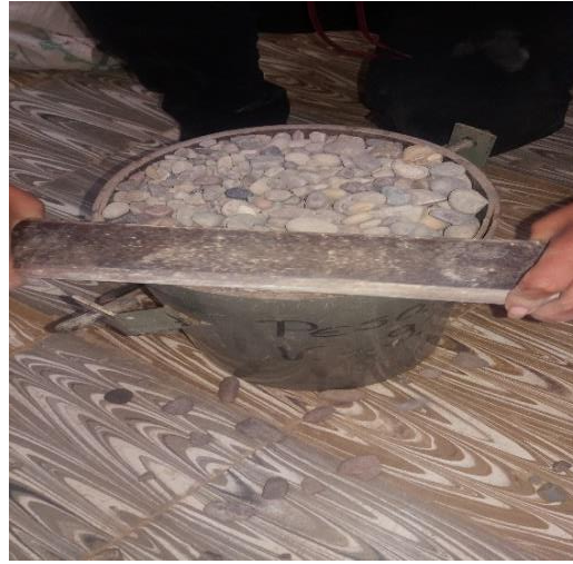
Figura 3.17. Enrazado con la regla metálica
