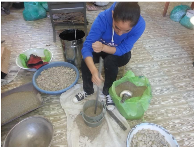
Figura 3.19. Varillando el material
