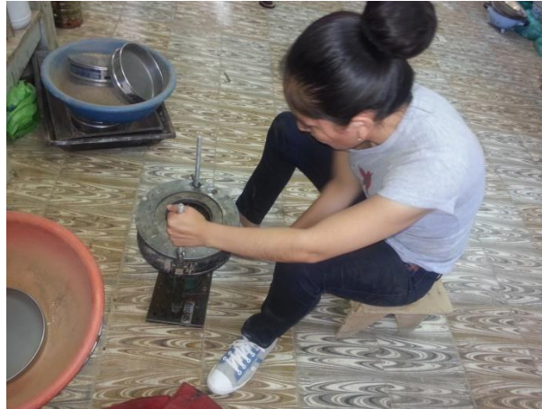
Figura 3.36. Desmoldando la briqueta
