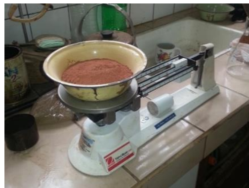
Figura 3.13. Pesando la muestra
