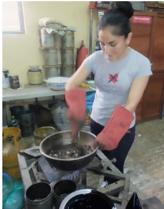
Figura 3.33. Mezcla del agregado pétreo con el cemento asfáltico
