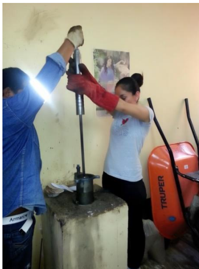
Figura 3.35. Compactación con martillo con 75 golpes por cara
