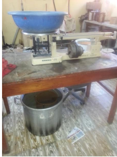
Figura 3.15. Peso de muestra en agua
