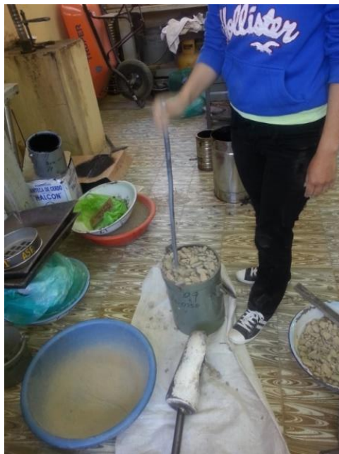
Figura 3.18. Varillado con la barra metálica
