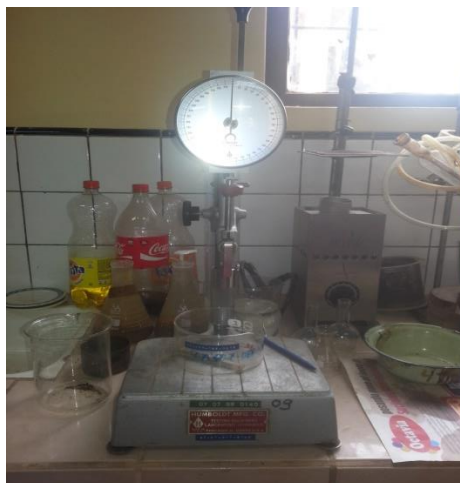
Figura 3.21. Lectura de penetración
