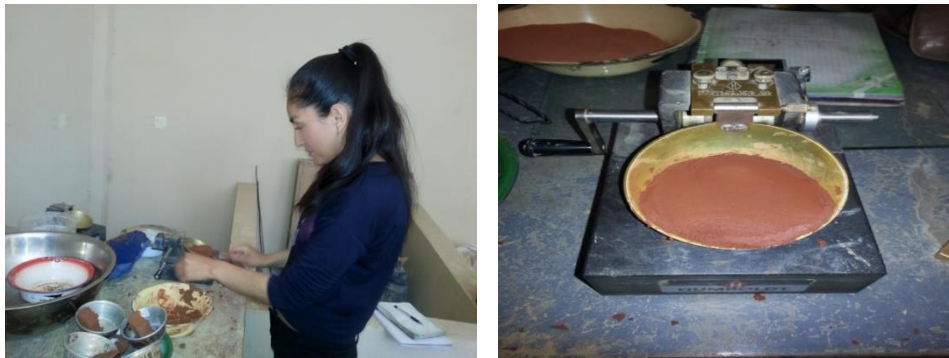
Figura 3.7. Realizando límite líquido de la laterita
