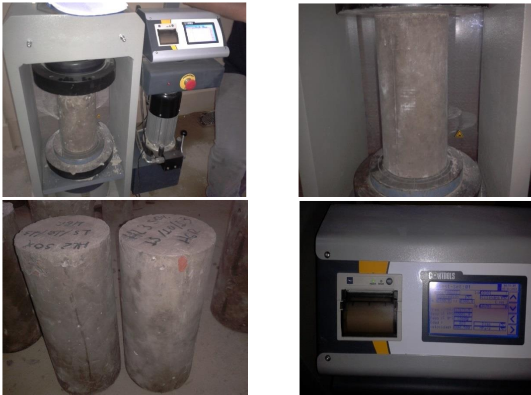
FIGURA 3.2.10-1: ENSAYOS DE ROTURA DE PROBETAS
