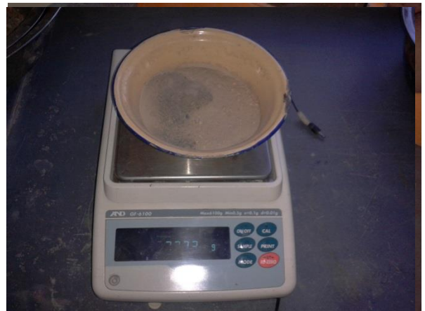
FIGURA 3.2.5-1: DETERMINACIÓN DEL PESO ESPECÍFICO Y ABSORCIÓN DEL AGREGADO FINO
