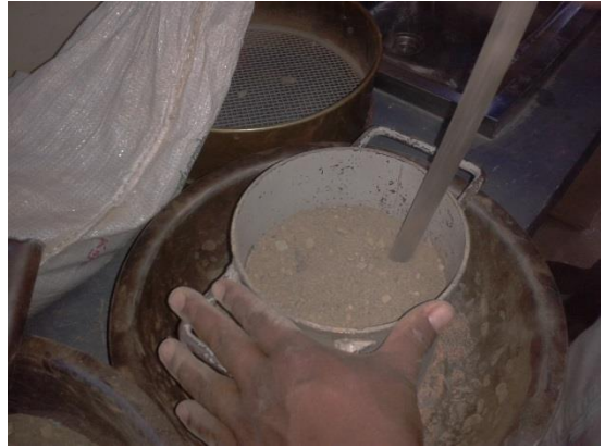
FIGURA 3.2.7-1: DETERMINACIÓN DEL PESO UNITARIO DEL AGREGADO FINO
