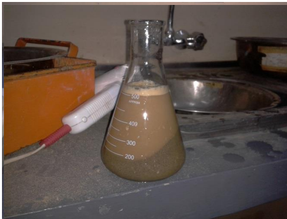
FIGURA 3.2.5-1: DETERMINACIÓN DEL PESO ESPECÍFICO Y ABSORCIÓN DEL AGREGADO FINO
