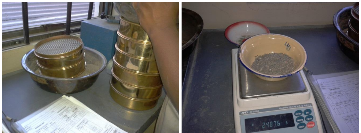
FIGURA 3.2.3-2: ANÁLISIS GRANULOMÉTRICO DEL AGREGADO FINO
