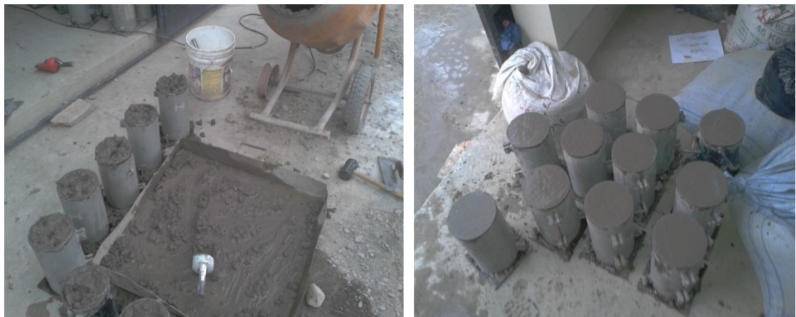
FIGURA 3.2.9-5: VACIADO Y REALIZACIÓN DE PROBETAS
