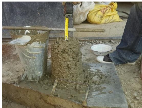
FIGURA 3.2.9-3: ENSAYO DE ASENTAMIENTO A LAS MEZCLAS REALIZADAS
