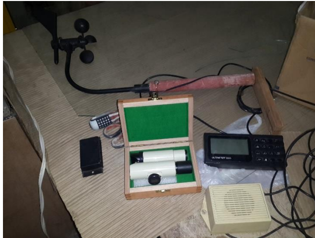
FIGURA 3.3.3-5 SENSORES VELOCIDAD VIENTO, TEMPERATURA Y HR
