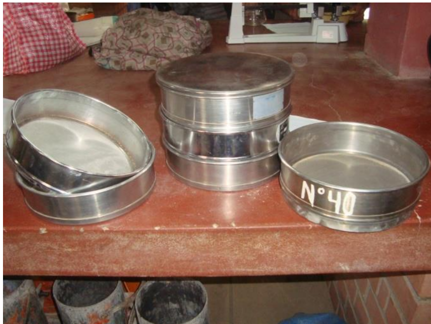
FIGURA 3.2.1-1: MATERIALES Y EQUIPO EMPLEADO PARA LA DETERMINACIÓN DE LA FINURA DEL CEMENTO
