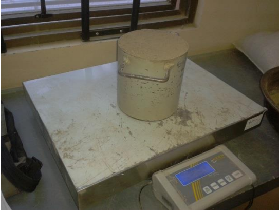
FIGURA 3.2.7-1: DETERMINACIÓN DEL PESO UNITARIO DEL AGREGADO FINO
