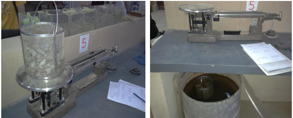
FIGURA 3.2.4-1: DETERMINACIÓN DEL PESO ESPECÍFICO Y ABSORCIÓN DEL AGREGADO GRUESO (GRAVA)
