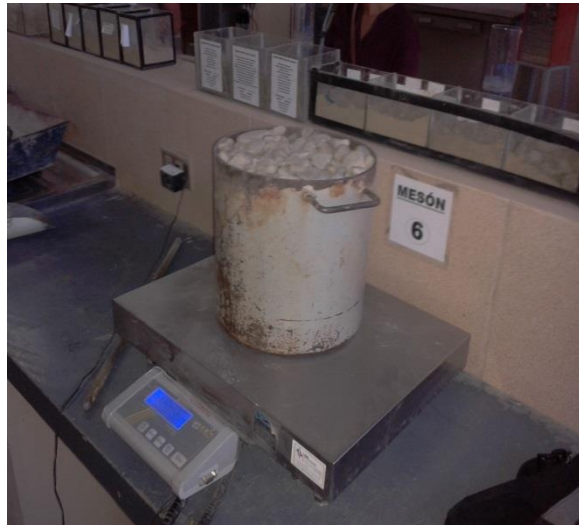
FIGURA 3.2.6-1: DETERMINACIÓN DEL PESO UNITARIO DEL AGREGADO GRUESO (GRAVA)
