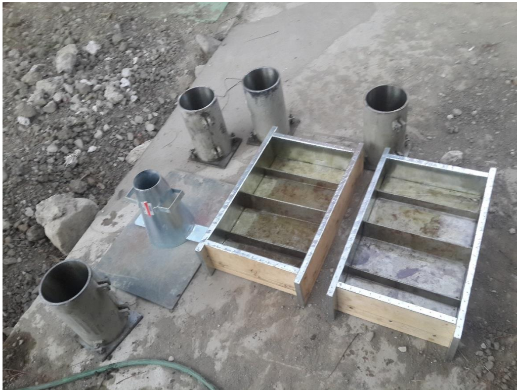
FIGURA 3.2.9-4 PROBETAS REALIZADAS Y MOLDES UTILIZADOS EN LA ELABORACIÓN DE MEZCLAS
