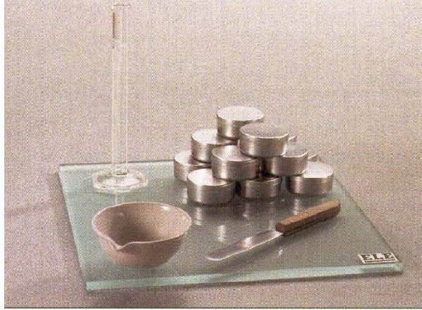
Equipo para realizar el ensayo de límite plástico, Fuente: Internet
