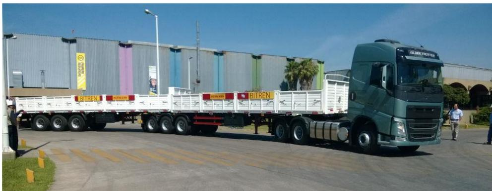
**BTL:** Representa vehículos de carga articulados compuestos por un caballo mecánico de 3 ejes, de tracción, por medio de dos articulaciones, 2 semiremolques y 3 ejes. El modelo representativo es el vehículo conocido como bitren de 9 ejes con una longitud total de 30 metros. También cubre vehículo Autotren, que consiste en un caballo mecánico con 3 ejes de tracción, por medio de tres articulaciones, dos 2-eje semi-remolque con Dolly intermedia de 2 ejes, con una longitud total de 30 metros.
