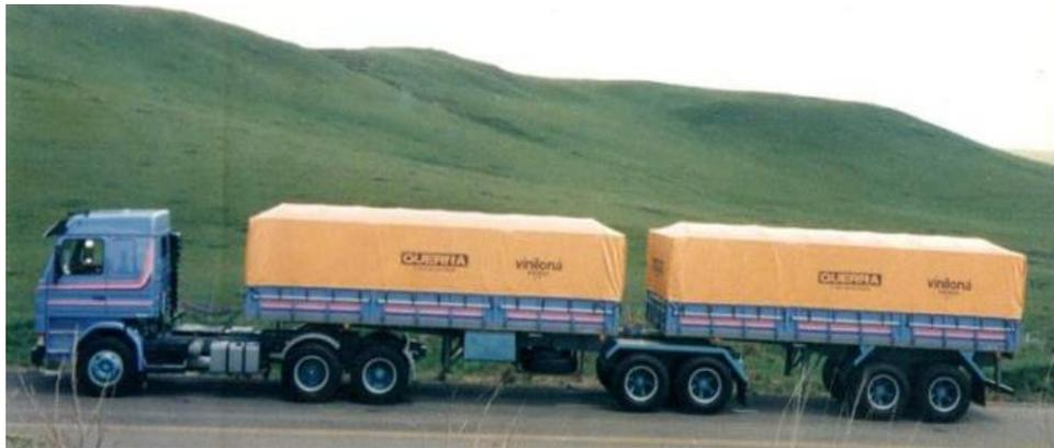
**BT9:** Representa vehículos de carga articulados compuestos por un caballo mecánico de 3 ejes, de tracción, por medio de dos articulaciones, 2 semiremolques y 3 ejes. El modelo representativo es el vehículo conocido como bitren de 9 ejes, con una longitud total de 25 metros.
