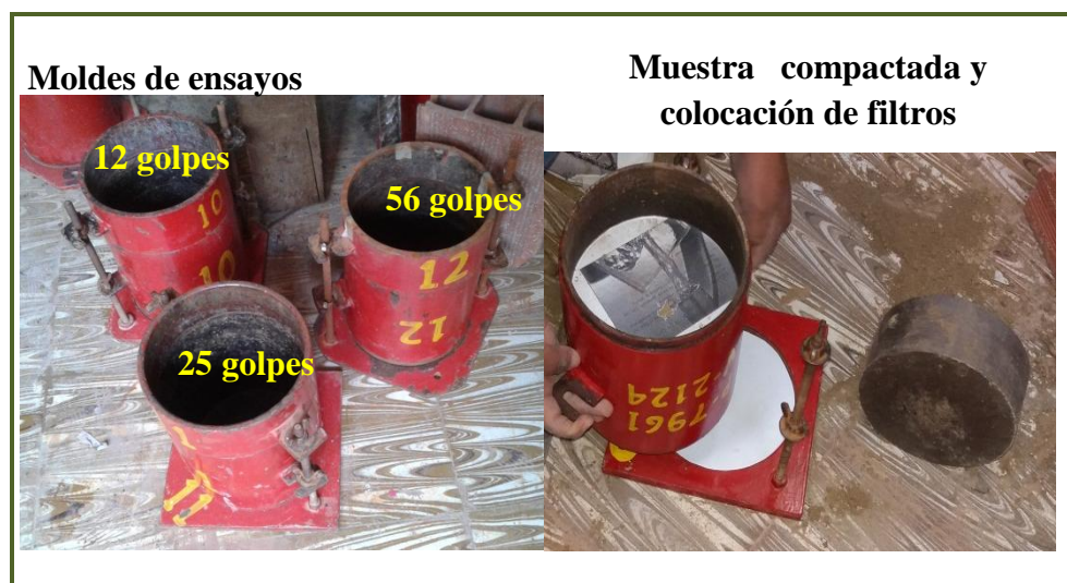
Figura 4.11. Compactación de la muestra con diferentes energías
