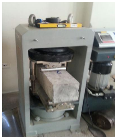
Figura 4.24. Rotura de la viga
