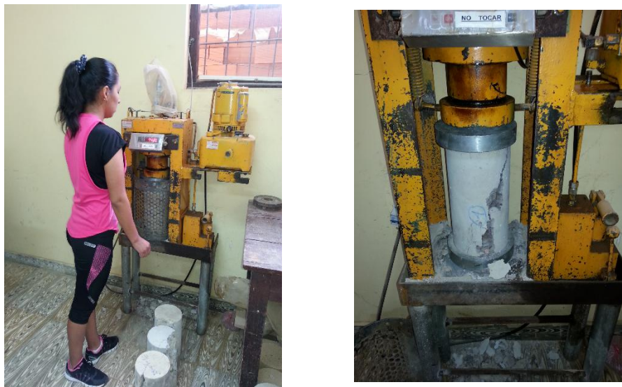
Figura 4.21. Rotura de la probeta a los 28 días
