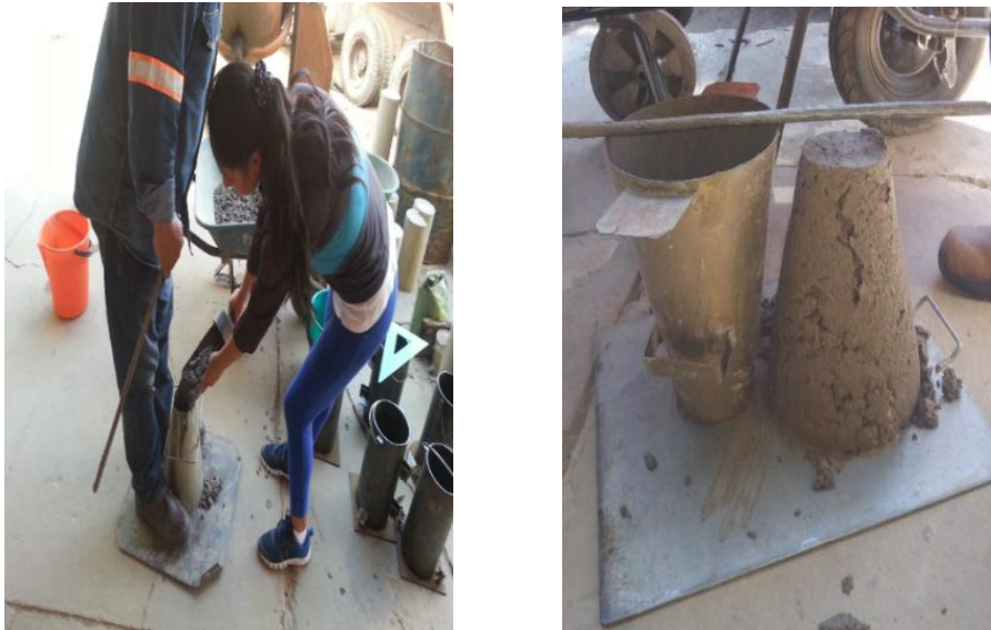
Figura 4.17. Realizando la medición de Asentamiento
