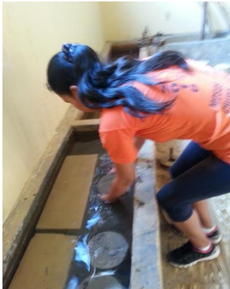
Figura 4.19. Curado de probetas
