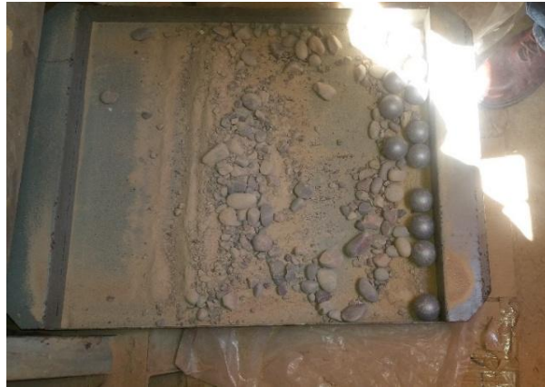
Figura 4.14. Muestra después del ensayo en la máquina de los ángeles.
