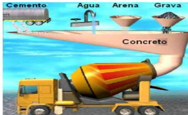
Figura 2.6. Elaboración de la mezcla de concreto
