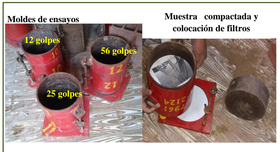
Figura 4.11. Compactación de la muestra con diferentes energías
