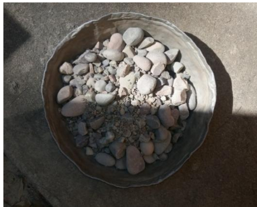
Figura 4.15. Peso de la muestra retenida en el tamiz N°12
