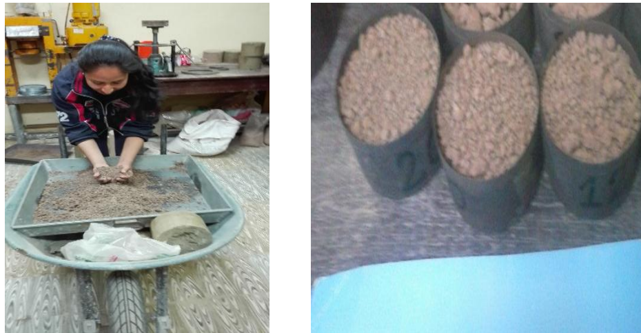
Figura 4.10. Preparación del material para el CBR y muestras para Contenido de Humedad
