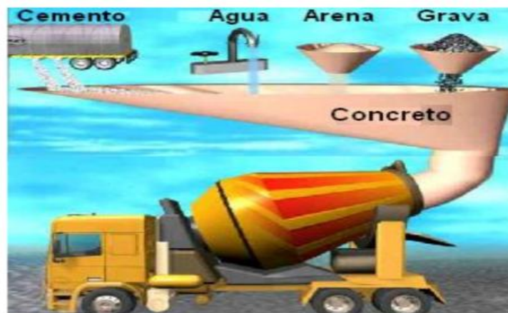
Figura 2.6. Elaboración de la mezcla de concreto
