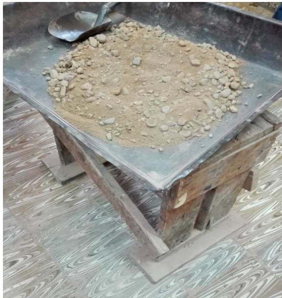
Figura 4.9. Muestra para realizar el CBR
