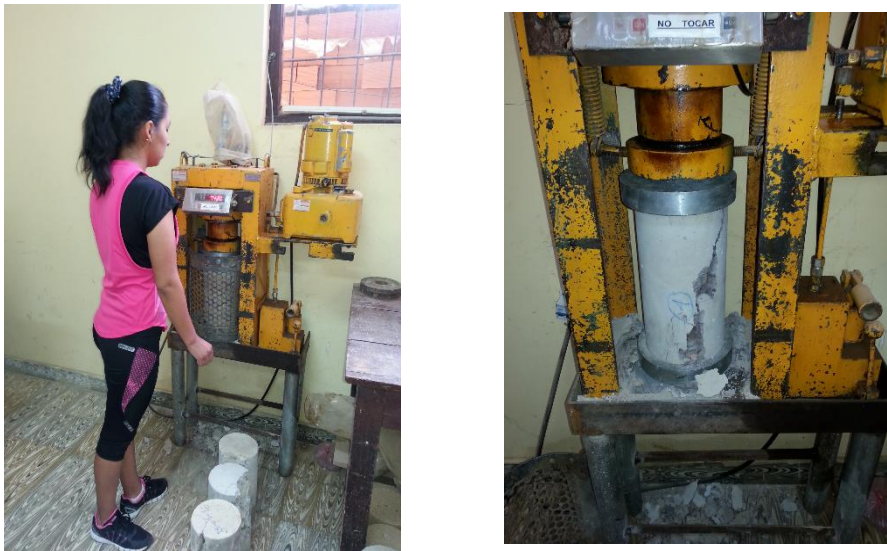
Figura 4.21. Rotura de la probeta a los 28 días
