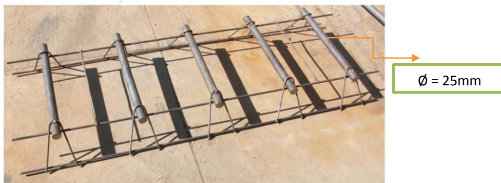
Figura 4.29. Diámetros del acero utilizados
