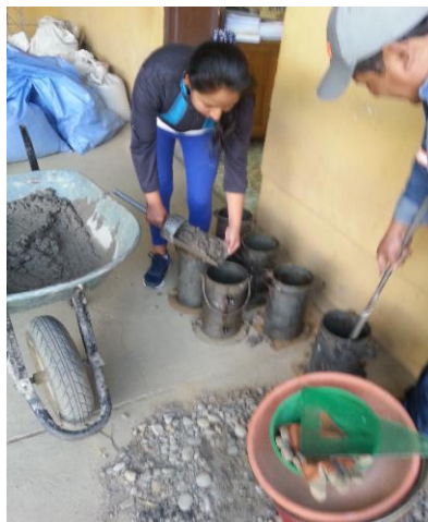
Figura 4.18. Varillado al hormigón
