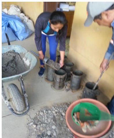
Figura 4.18. Varillado al hormigón
