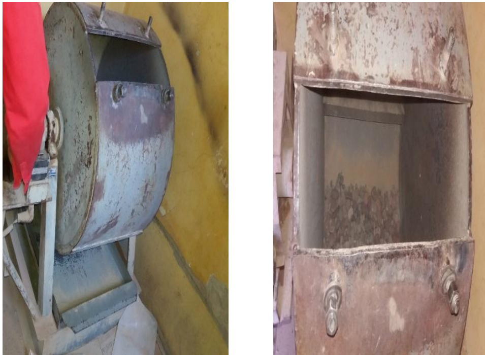
Figura 4.13. Colocado de la muestra en la máquina de los ángeles con el N° de esferas correspondiente.
