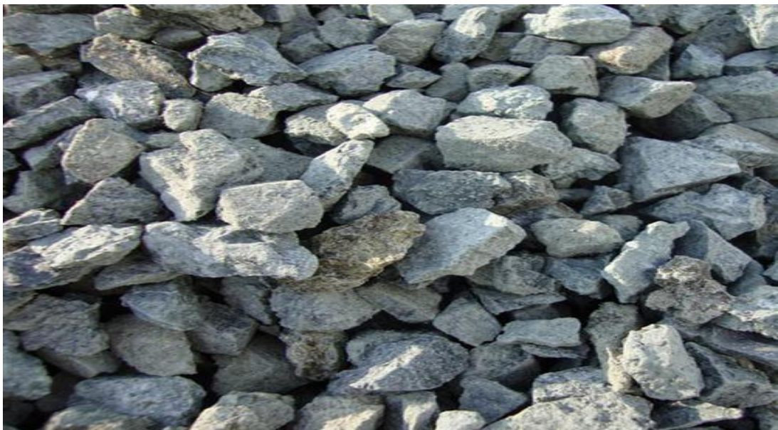
FIGURA 13 RESIDUO TRITURADO DE LOSAS DE HORMIGÓN RÍGIDO
