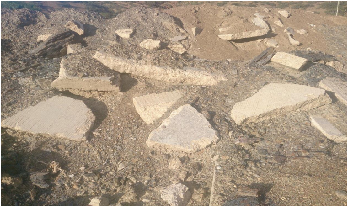
FIGURA 12 RESIDUO DE LOSAS DE HORMIGÓN DE PAVIMENTO RÍGIDO
