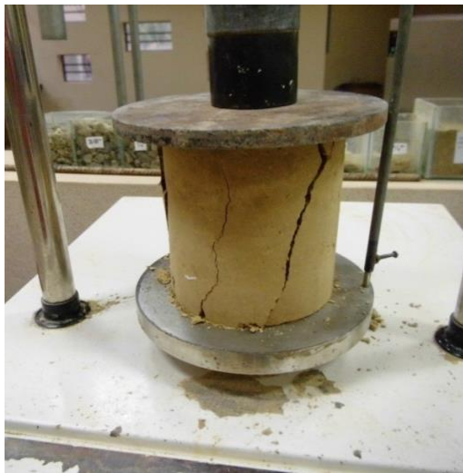
Fisuras después de la falla del suelo sin cal
