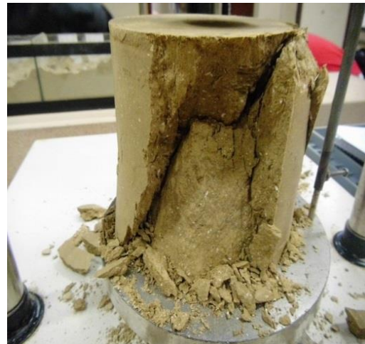
Probeta de suelo-cal después de la falla
