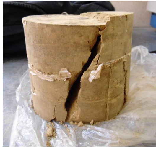
Probeta de suelo-cal después de la falla
