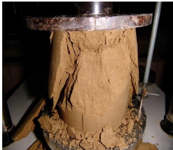
Probeta de suelo solo después de la falla
