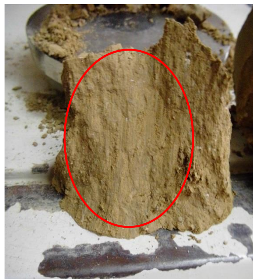
Fricción del suelo cal después de la falla en la línea de fisura
