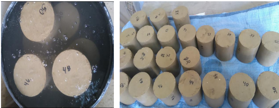
Humedecimiento del Suelo cal en el primer ciclo
