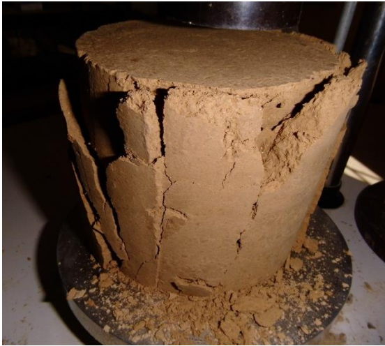
Probeta de suelo solo después de la falla
