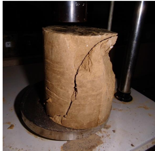
Probeta de suelo-cal después de la falla
