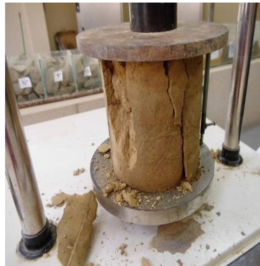
Fisuras después de la falla del suelo sin cal
