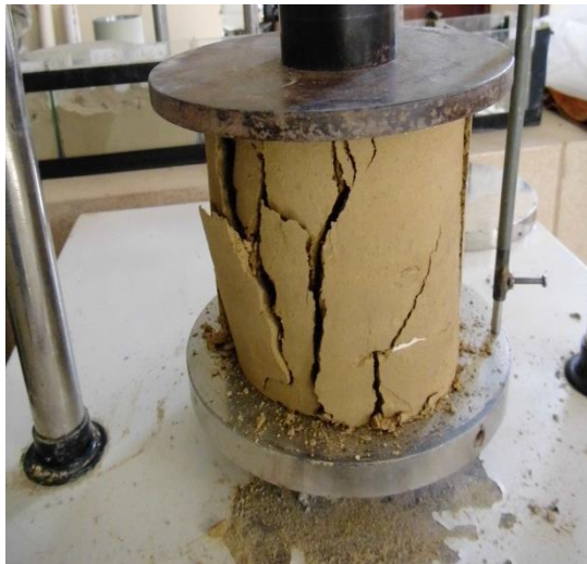
Probeta de suelo solo después de la falla
