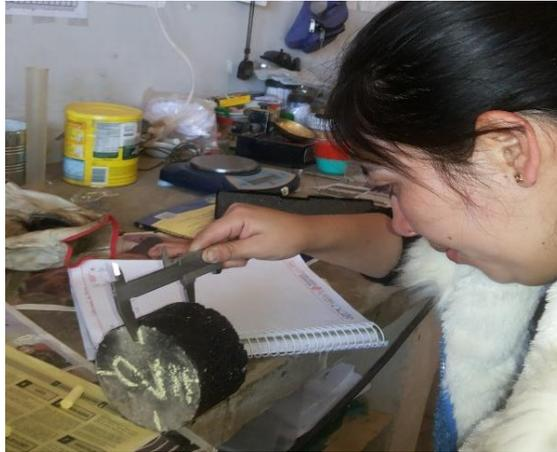
**FIGURA 1.8.33 Determinación de Alturas en Briquetas<sup>78</sup>**
