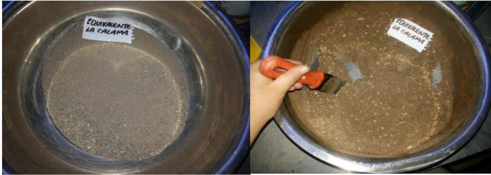
*El material que pasa el tamiz N°4 es secado en el horno y posteriormente humectado.*
