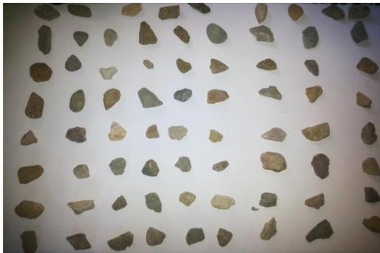
*Figura 1.8.11 Análisis de Caras Fracturadas<sup>23</sup>*
