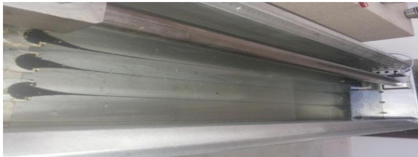
**Figura 1.8.18 *Ductilidad del Asfalto***<sup>31</sup>
