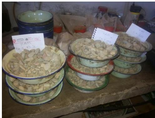
*Material preparado para cada briqueta según el % de asfalto utilizado*
