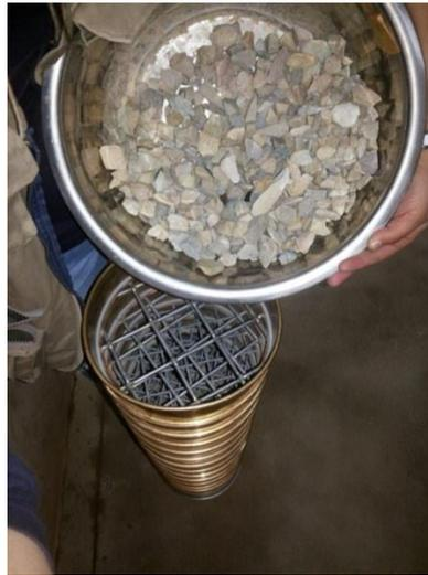
**Figura 1.8.7 Granulometría de Agregados Pétreos<sup>19</sup>**
