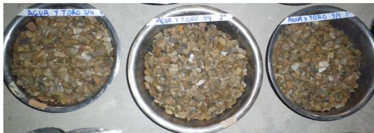
*-El material saturado finalmente es secado en el Horno para obtener la absorción del material*
