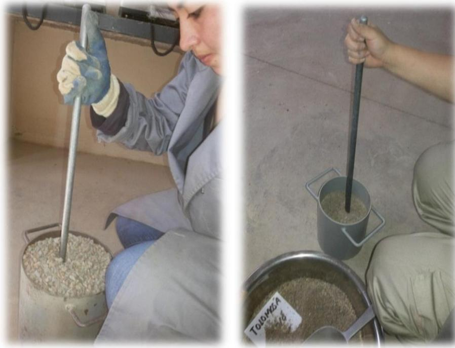
**Figura 1.8.9 Determinación del Peso Unitario en Agregados Finos y Gruesos<sup>21</sup>**
