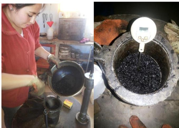
*Colocado de muestra en el molde y control de la temperatura de compactación*
