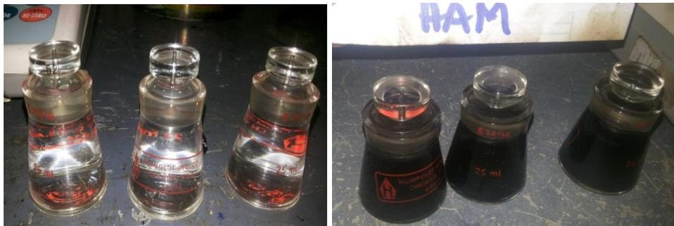
*Picnómetros con agua destilada para su calibración y con material*
