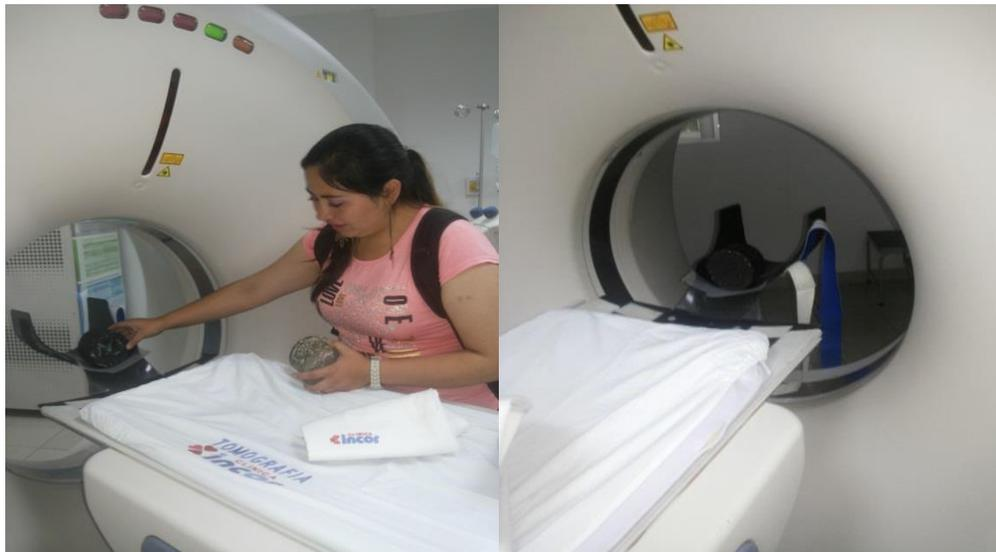
*Colocado de muestra en el tomógrafo computarizado Helicoidal, para la obtención de imágenes monocromáticas*
