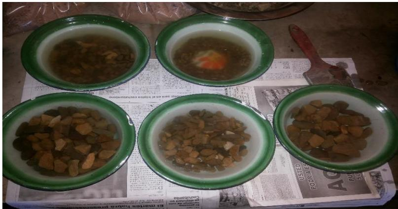
*Las muestras son sumergidas en la solución de sulfato de sodio*
