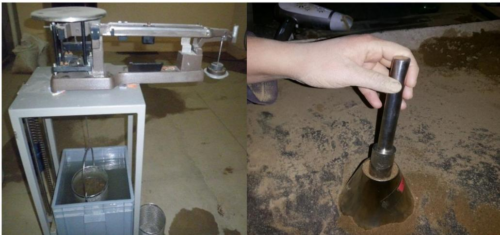
**Figura 1.8.8 Ensayo de Peso Específico en Agregados pétreos<sup>20</sup>**
