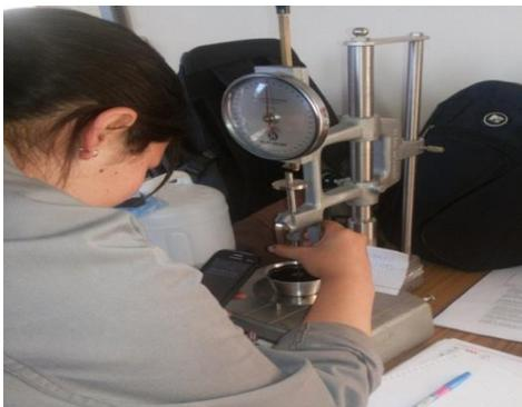
**Figura 1.8.16 Ensayo de Penetración en Asfalto<sup>29</sup>**
