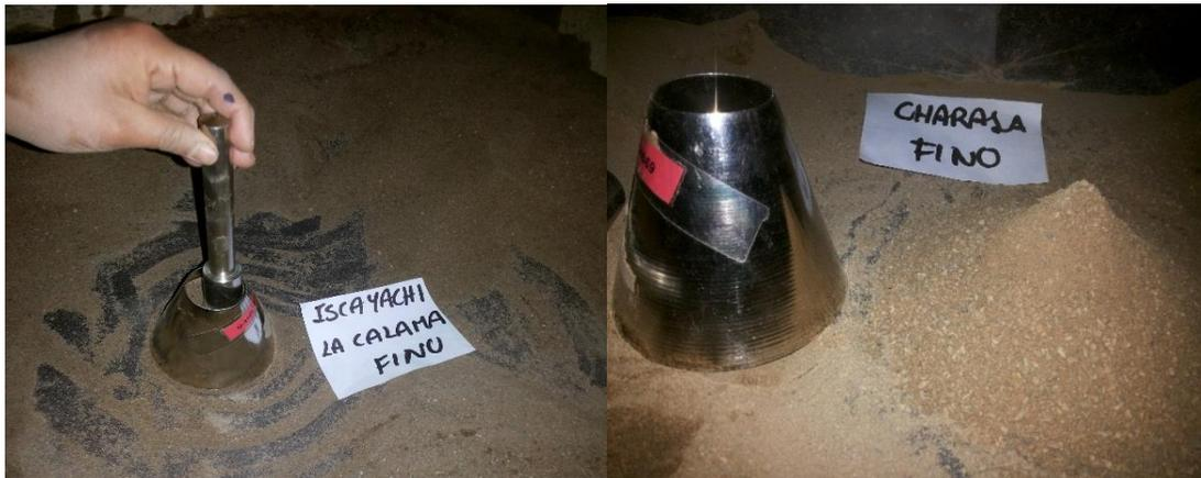
*-Se comprueba que el material se encuentra con superficie seca pero saturada con el pistón y molde tronco-cónico*
