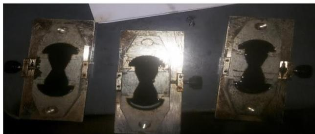
*Moldes de latón con muestras de asfalto*
