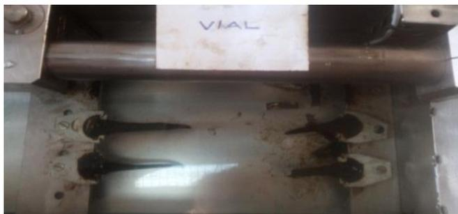
*Figura 1.8.22 Recuperación Elástica del Asfalto 60/85<sup>35</sup>*
