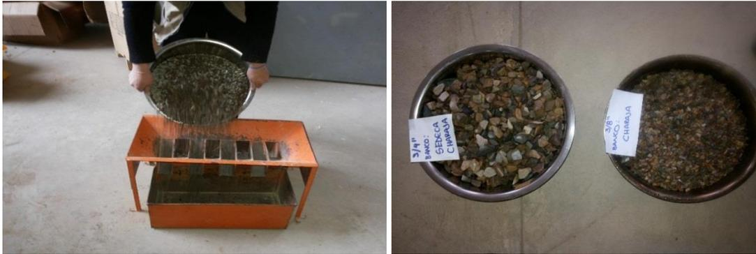
*- La muestra es cuarteada y posteriormente lavada para poder determinar con mayor exactitud el contenido de fino.*
