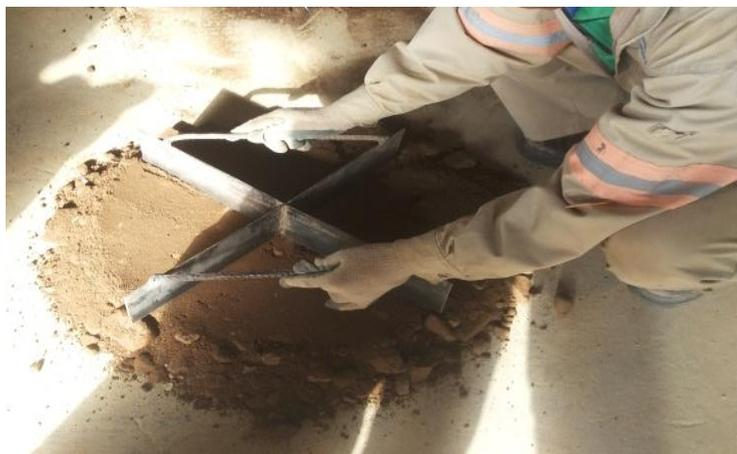
**Figura 1.8.6 Cuarteo de Muestras Manualmente<sup>17</sup>**
