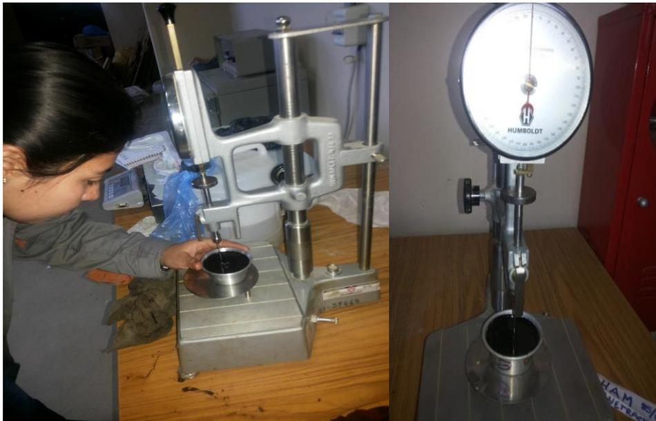
*Muestras sometidas en el penetrómetro*
