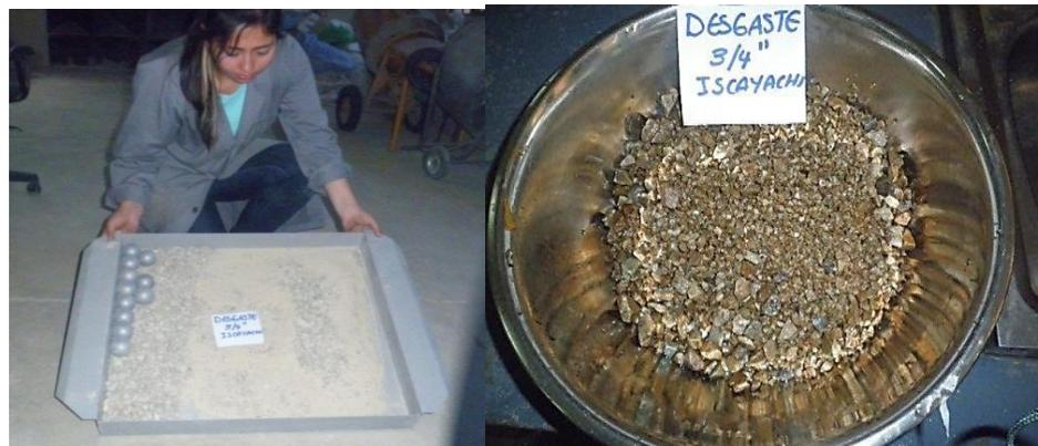
*Material después de realizado el ensayo*
