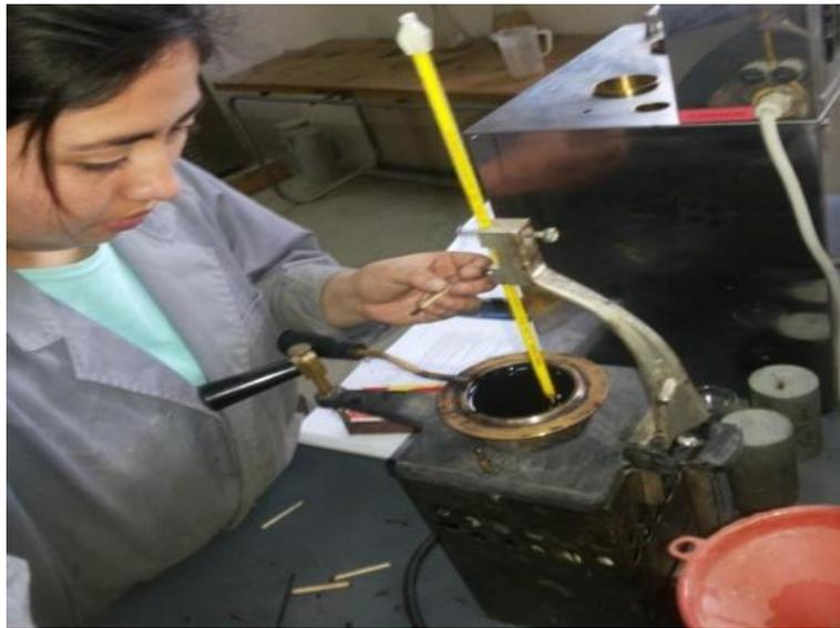
**Figura 1.8.19 Punto de Inflamación del Asfalto<sup>32</sup>**
