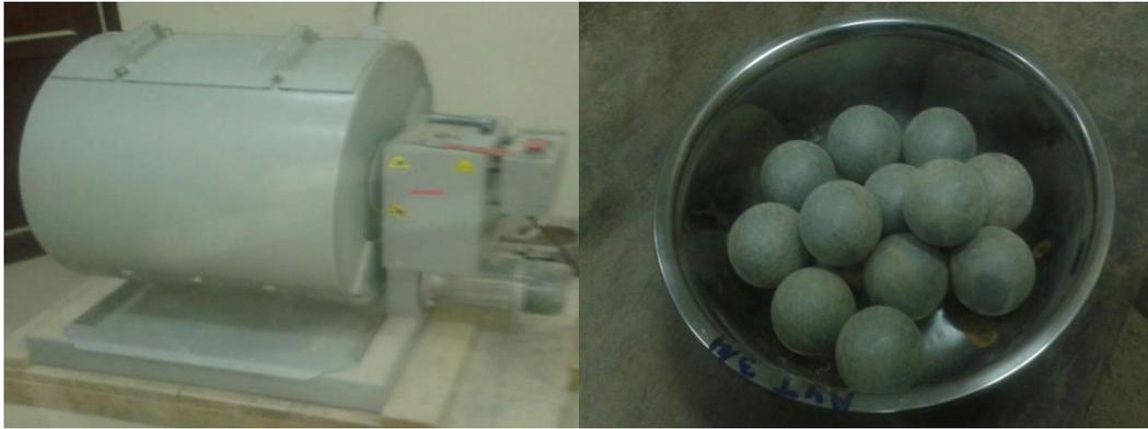
*Figura 1.8.10 Equipo Utilizado en Ensayo de Desgaste de los Ángeles<sup>22</sup>*
