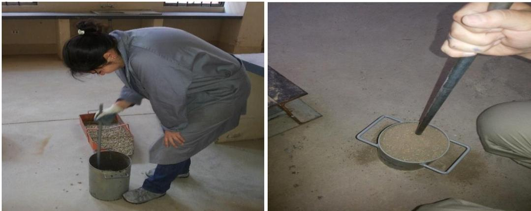
*-Los agregados son colocados compactado y suelto en un molde cilíndrico de volumen conocido.*
