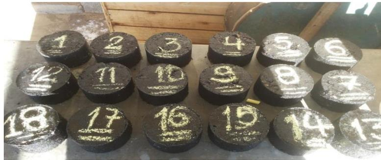
*Briquetas de prueba para estimación del porcentaje óptimo de cemento asfáltico*
