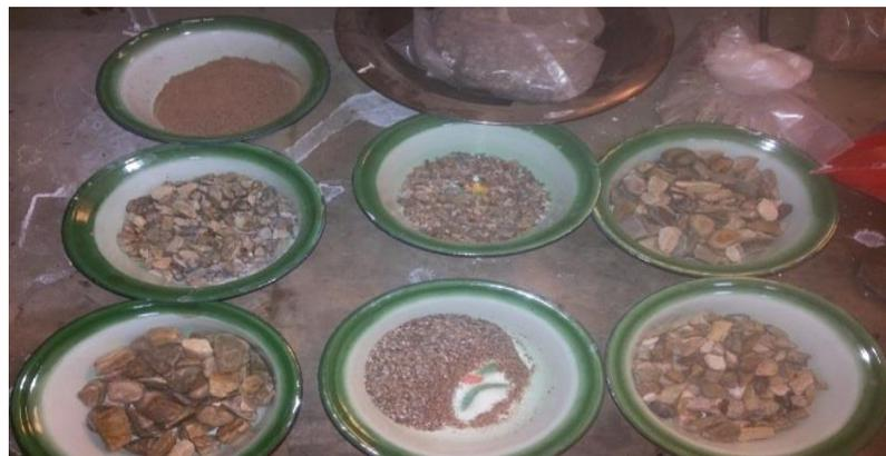
*Muestras secadas después de un ciclo del ensayo de durabilidad.*
