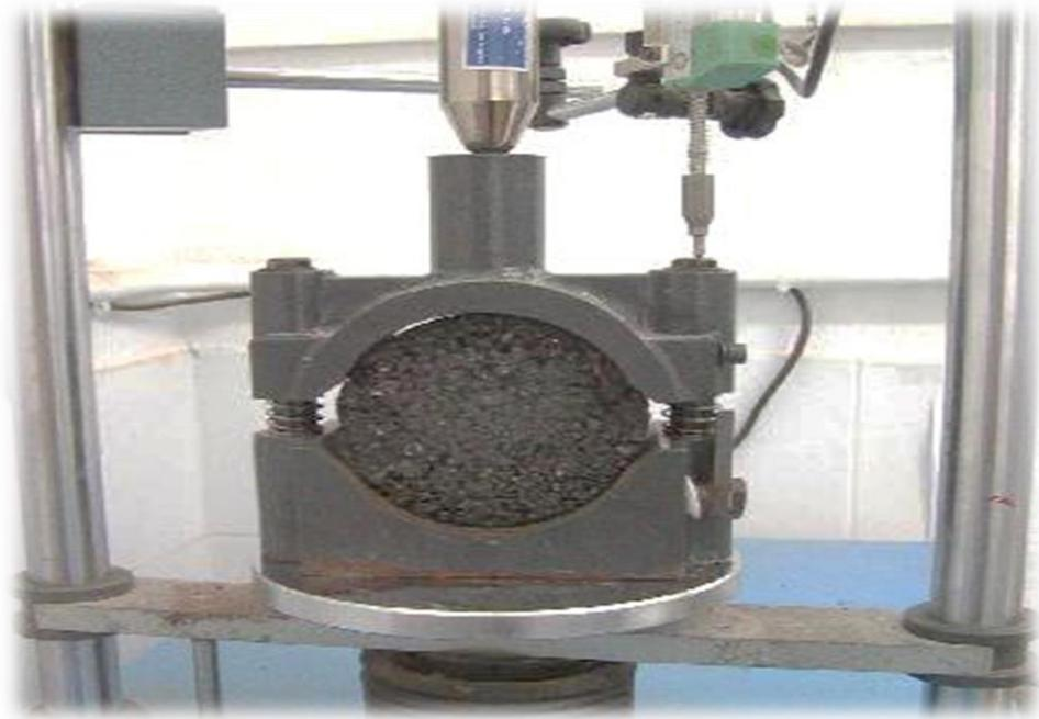
**Figura 1.8.3 Ensayo de fluencia y estabilidad a briketa<sup>12</sup>**
