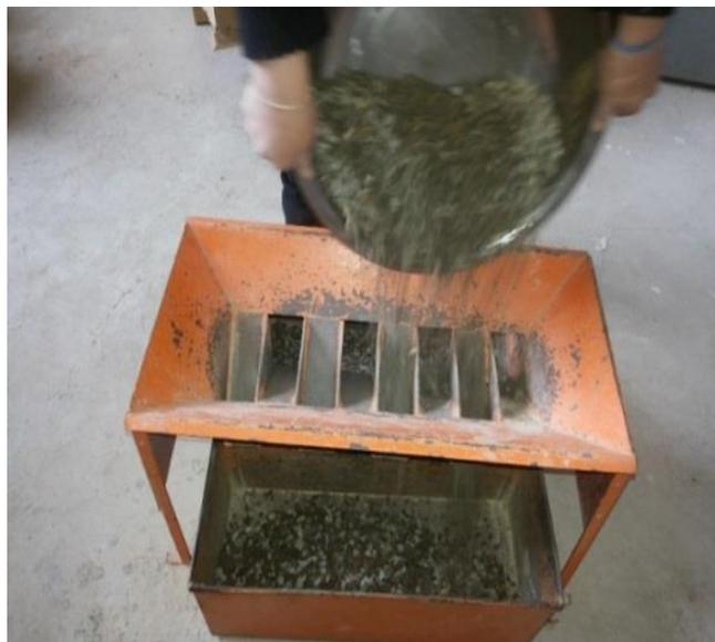
**Figura 1.8.5 Cuarteo Mecánico de Materiales<sup>16</sup>**
