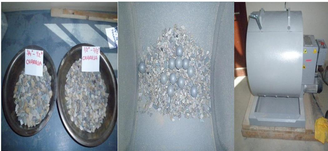
*La muestra lavada y secada en horno es puesta en la máquina de "Los Ángeles":*
