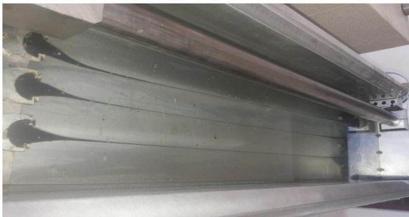
*Ensayo en proceso en ductilímetro*
