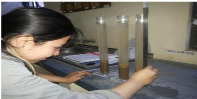
**Figura 1.8.13 Ensayo de Equivalente de Arena<sup>25</sup>**
