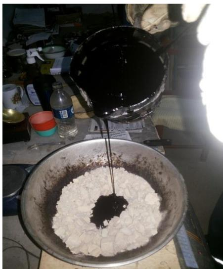
*Colocado del cemento asfáltico*
