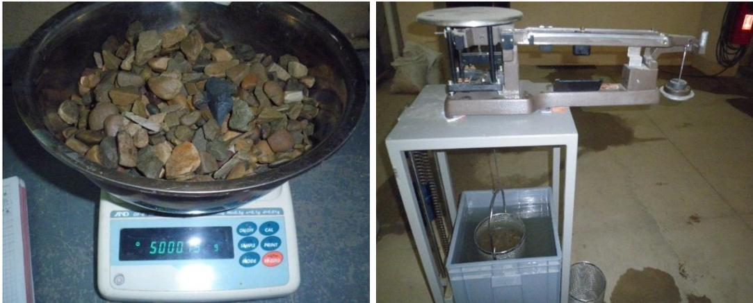
*-Se seca la muestra superficialmente para ser colocada en el canastillo y ser pesado.*
