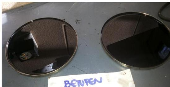
*Placas metálicas con material asfáltico*
