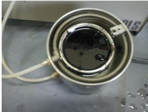
*Fuente: Elaboración Propia**Imagen 3.51: Realización del ensayo de penetración.*
