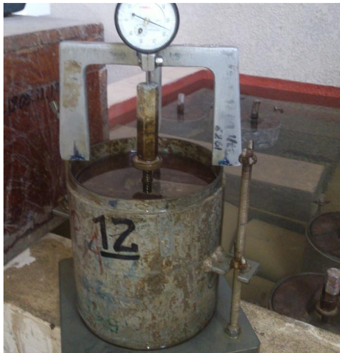
Imagen 1. (Equipo para medir hinchamiento)
