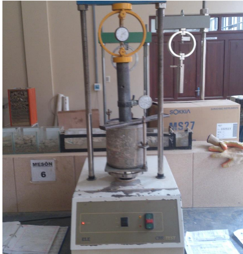
Imagen 2. (Prensa hidráulica para la prueba de Penetración)
