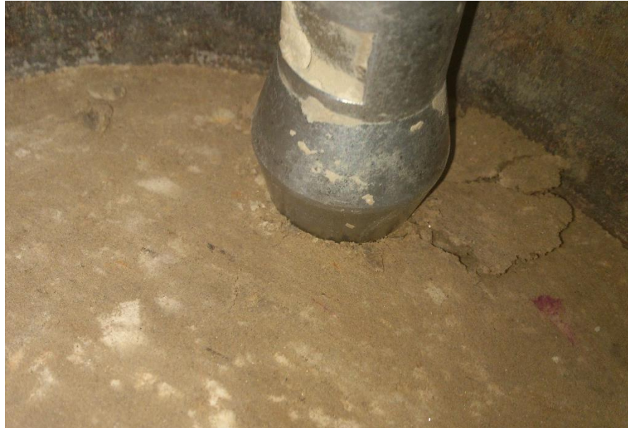
Imagen 8. (Penetración del cono hasta la mitad de su altura)
