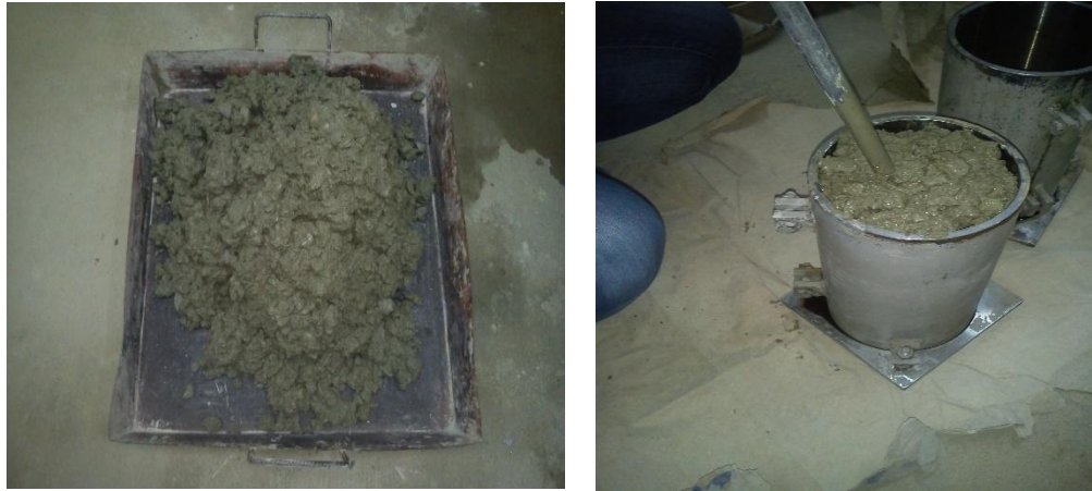
Imagen 20: Varillado y Compactación Manual de la Mezcla de Hormigón
