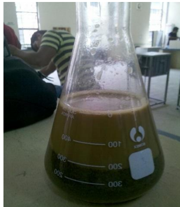
Imagen 11: Picnómetro para el ensayo de Peso Específico del agregado fino
