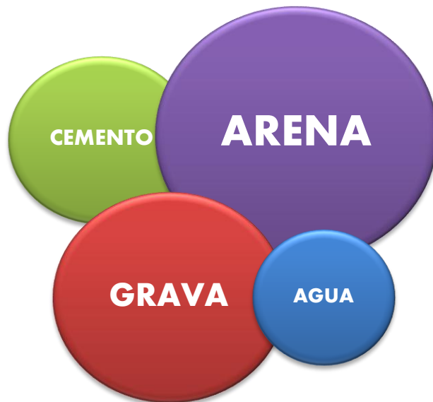
Figura 6: Componentes del Concreto Hidraulico
