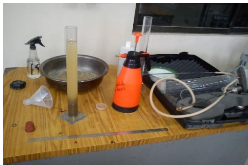
Imagen 12: Instrumentos para el ensayo de Equivalente de Arena
