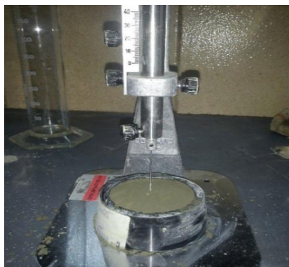
Imagen 16 Aparato Vicat para ensayo de Consistencia
