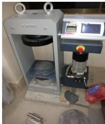
Imagen 23: Prensa Hidráulica para todo tipo de rotura
