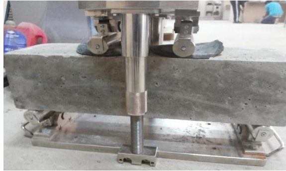
Imagen 25: Montaje de la viga en el Equipo de Flexión
