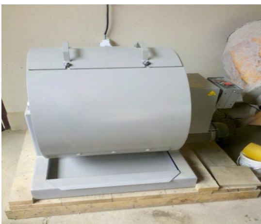
Imagen 8: Maquina del Desgaste los Ángeles
