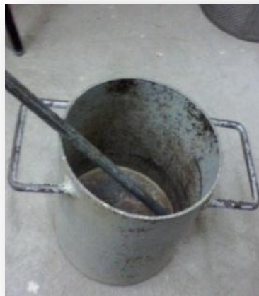
Imagen 10: Equipo de PU suelto para el agregado fino
