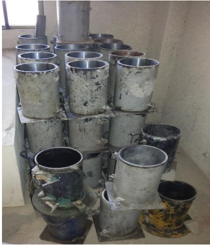
Imagen 17: Moldes para ensayos a compresión y Flexión
