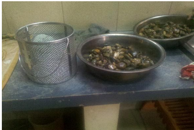
Imagen 7: Material y Equipo para el Peso específico Grava
