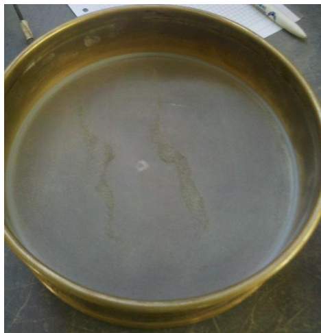
Imagen 15: Finura del cemento por el Tamiz N°200
