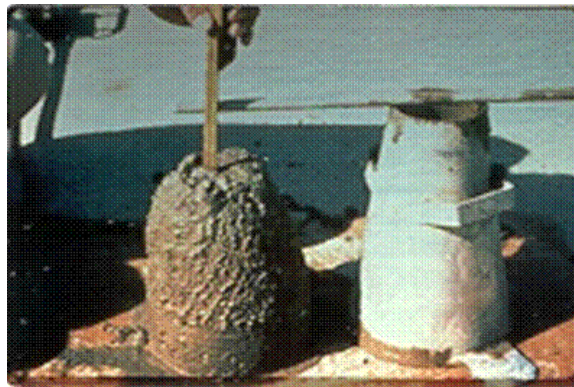
Imagen 1: Ensayo de Abrams
