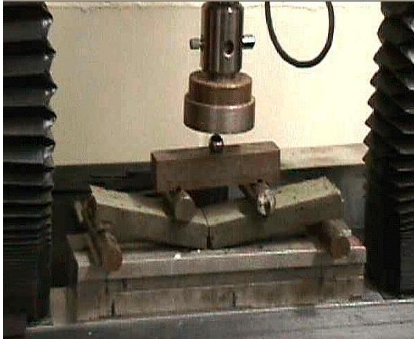
Imagen 3: Ensayo de Viga a Flexión
