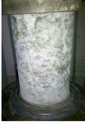
Imagen 22: Rotura de Testigos de Hormigón a Compresión
