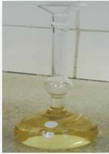
Imagen 14: Frasco Le Chatelier para peso específico del Cemento
