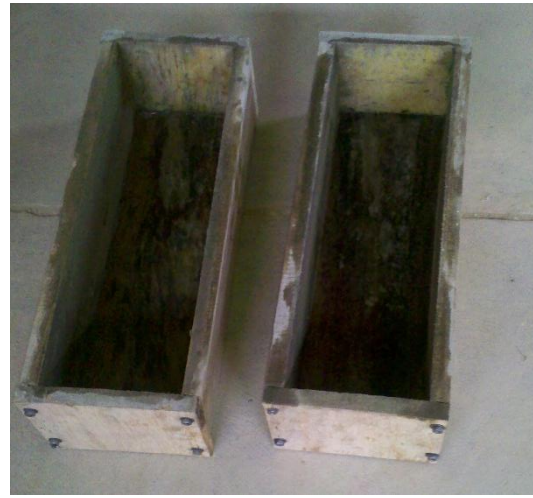
Imagen 17: Moldes para ensayos a compresión y Flexión
