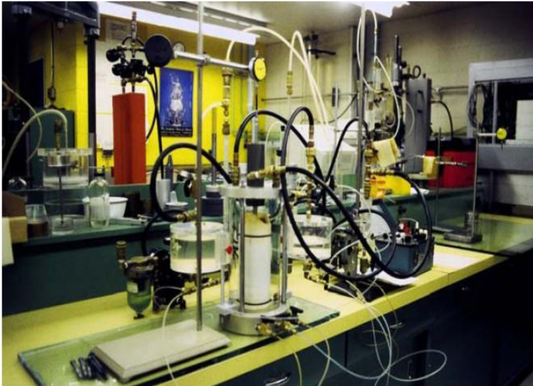
Fig. 2.12. Ilustración de una cámara triaxial y el concepto de módulo de Resiliencia
