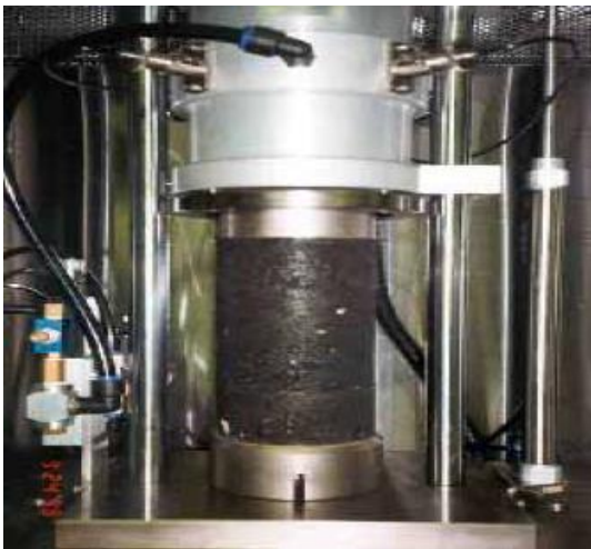
Fig. 2.11. Ensayo de módulo dinámico en mezclas asfálticas
