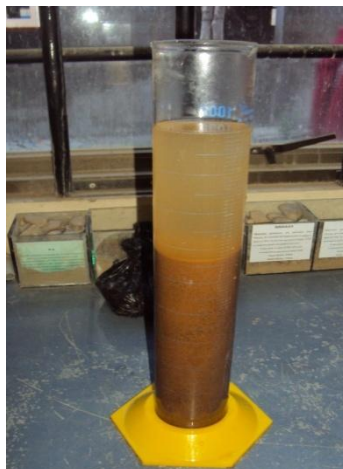
Foto N° 4 Equivalente de Arena
