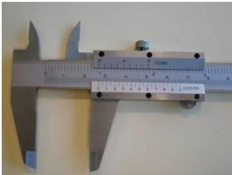
Fig. 3.12. Vernier para medir el ancho de las fisuras
