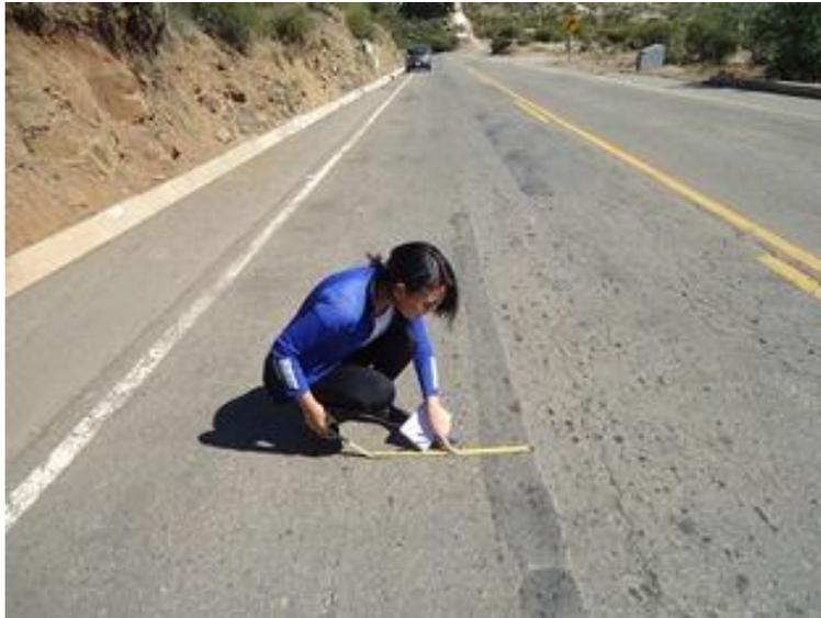
Fig. 3.11. Medición de longitud de Fallas Superficiales con Flexómetro
