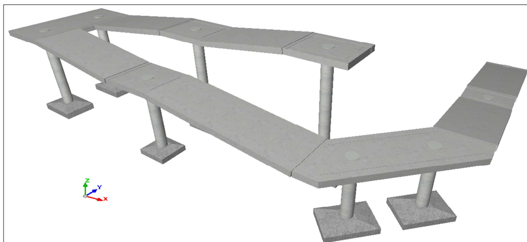
FIGURA 4.9. – RAMPA PARA PERSONAS CON DISCAPACIDAD
