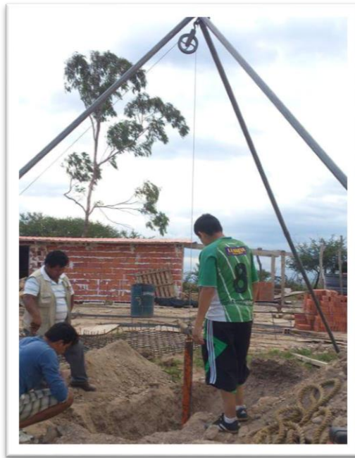
Ilustración 1: Equipo Ensayo SPT, Elaboración Propia
