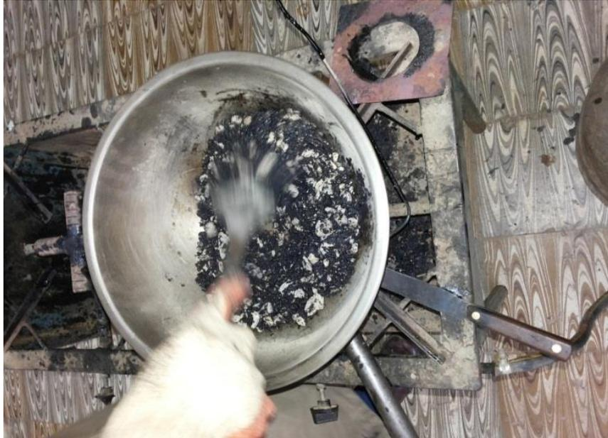
6. Una vez que la mezcla adquiere la temperatura de mesclado se saca del calor, para poder enfriar hasta que llegue a temperatura de compactación.
