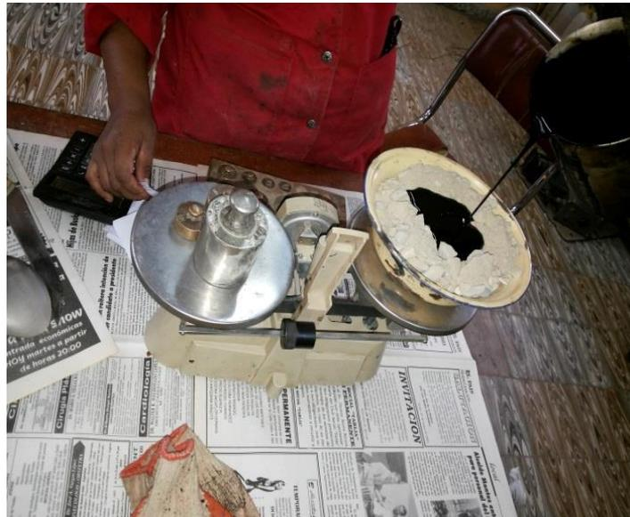
5. Se traspara la muestra a un bol, para poder mezclas con temperatura producida por una cocinilla.
