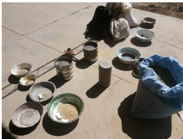
2. Se realizó el pesaje de los agregados en sus diferentes proporciones.
