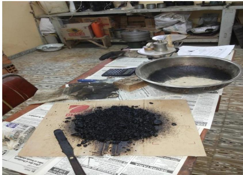
7. La mezcla enfriada se traspasa a los moldes de MARSHALL, para su compactación.
