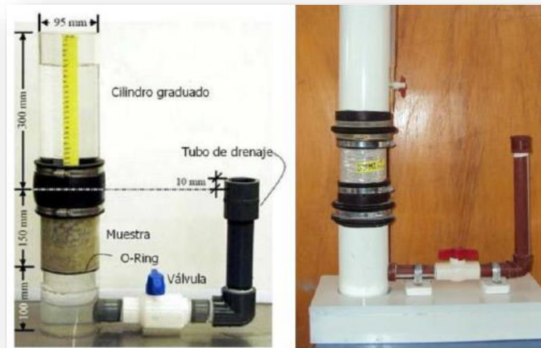
Figura 2. Equipos de ensayos de permeabilidad recomendados por ACI
