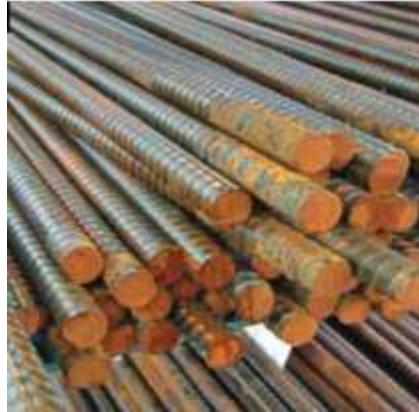
Figura 3.3: Pernos de anclaje para suelo o roca (Geobrugg A Company of the BRUGG Group)
