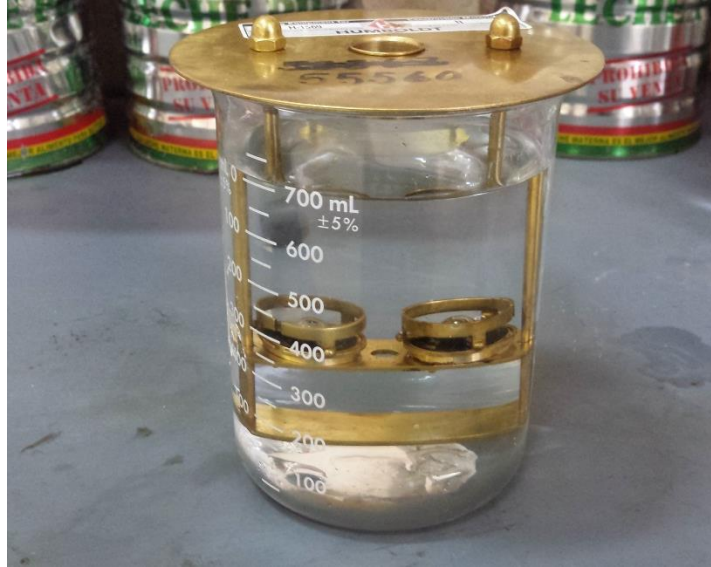
Figura 3.22 Equipo para el ensayo de punto de ablandamiento
