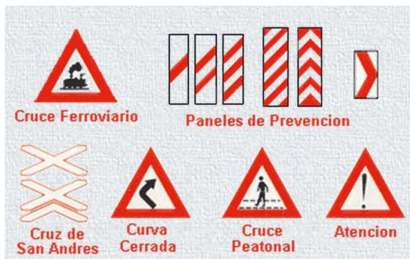
Figura 2.14. Señalización de advertencia
