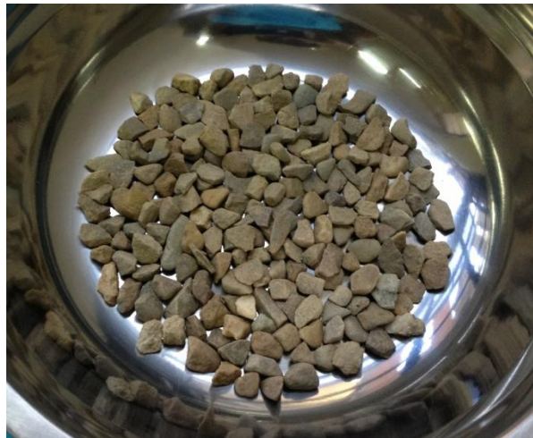
FIGURA 3.15. Muestra de 200 partículas
