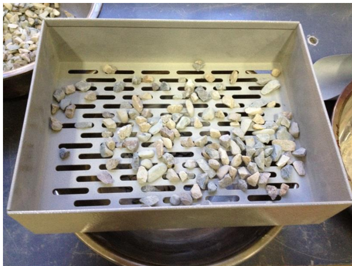
FIGURA 3.16. Separación de partículas Lajasas.
