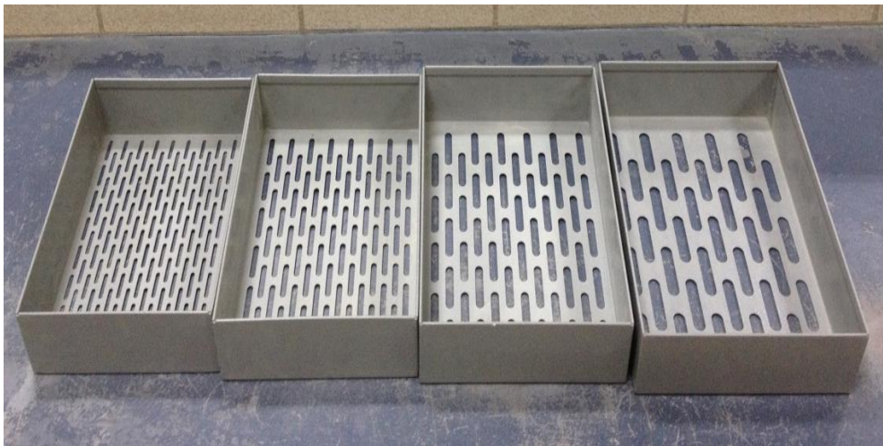
FIGURA 3.14. Juego de Calibradores de lajas.
