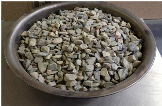
FIGURA 3.8. Agregado Grueso Constructora Erika.
