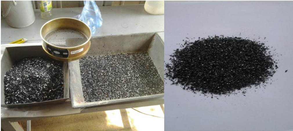
Figura N° 3.1 Residuos electrónicos pasantes del tamiz 10 y 100
