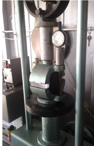
Figura N°1.22 Ensayo Marshall de estabilidad y flujo
