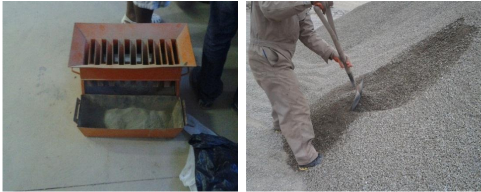
Figura N° 4.2 Reducción de muestras de agregado: Método del cuarteo manual
