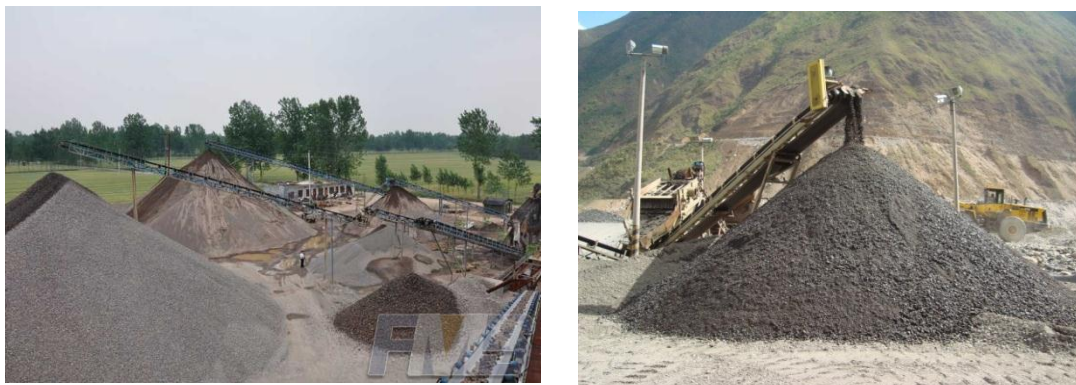
Figura N° 2.13 Producción y almacenamiento de agregados
