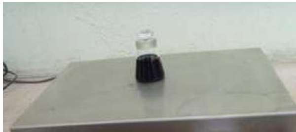
Figura N° 1.9: Pesando el conjunto picnómetro + asfalto
