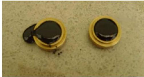
Figura N°1.16: Preparacion de muestra en los anillos de bronce
