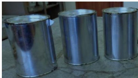
Figura N° 4.3 Recipientes metálicos para muestreo de cemento asfáltico
