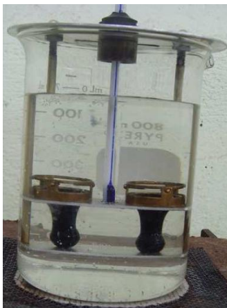
Figura N° 1.18: Punto de reblandecimiento (Metodo Anillo y Bola)
