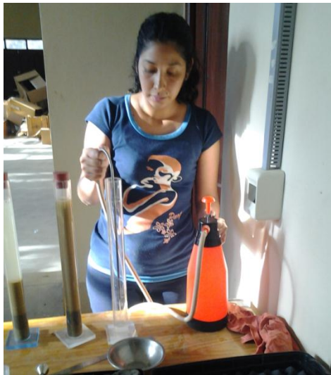
Figura N° 1.7: Adición de cloruro de calcio
