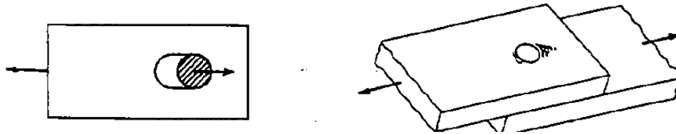
Figura 3.9 Falla por aplastamiento de las planchas.
