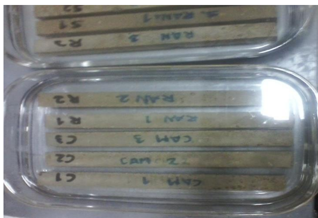
FOTOGRAFÍA. III-12 BARRAS ALMACENADAS EN LA SOLUCIÓN.
