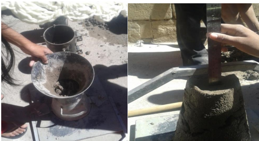
FOTOGRAFÍA III-14 VERIFICACIÓN DEL ASENTAMIENTO DE LA MASA DE HORMIGÓN FUENTE: Elaboración propia
