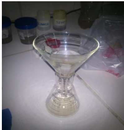
FOTOGRAFÍA III-6 FILTRADO DE LAS MUESTRAS
