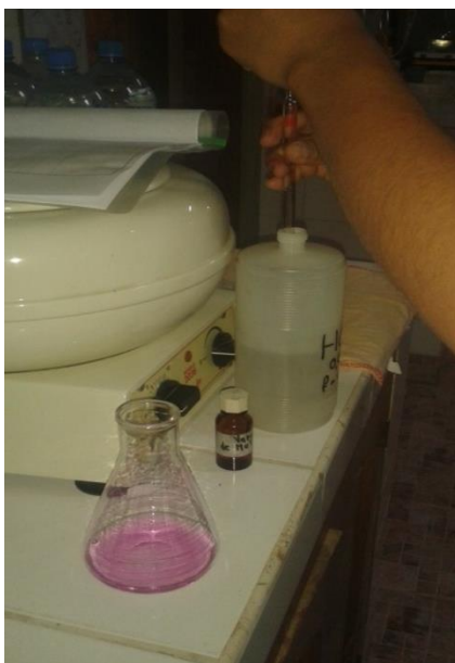
FOTOGRAFÍA III-10 VALORACIÓN CON HCl DE LA SOLUCIÓN CON FENOLFTALEINA FUENTE: elaboración propia
