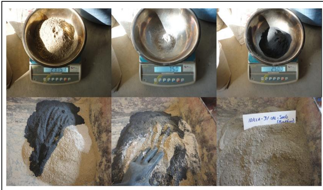
Figura 3.14: Preparación de mezcla S-CAL-CCA
