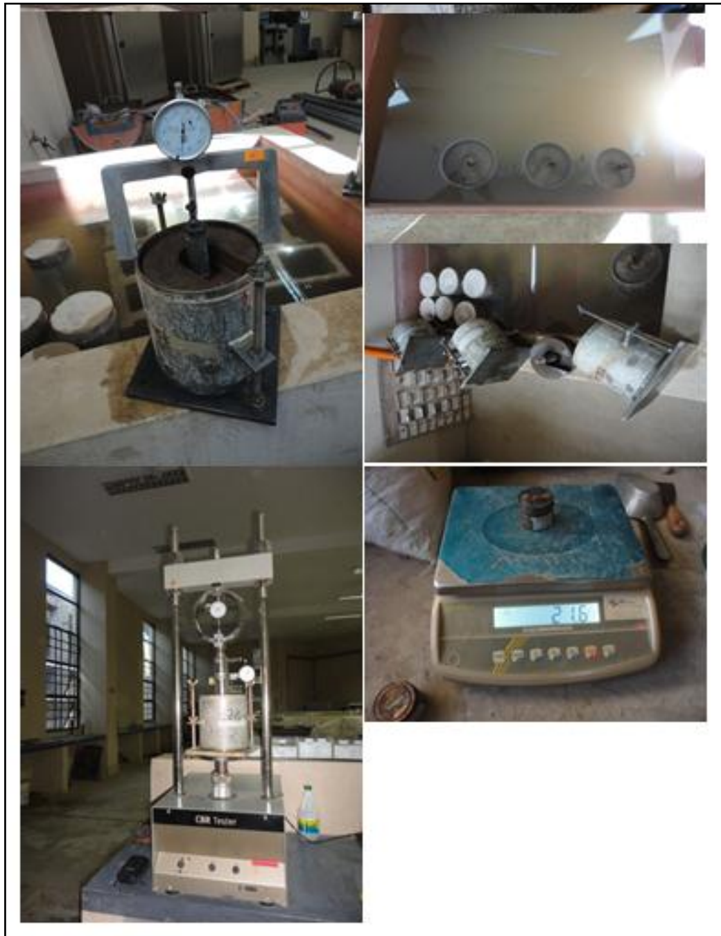
Figura 3.10: Proceso de inmersión y penetración del ensayo de CBR
