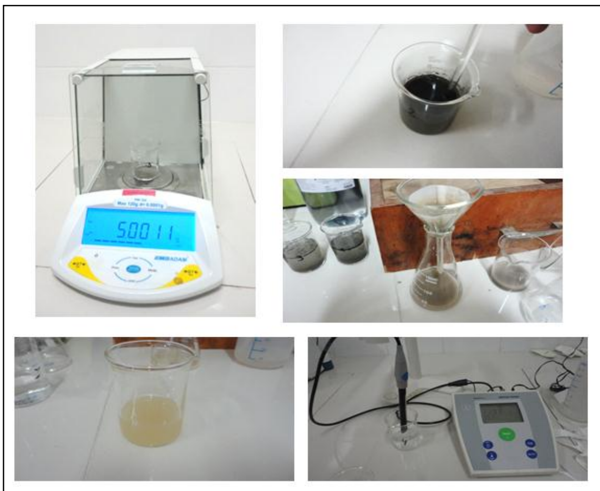
Figura 3.12: Proceso del ensayo para determinar el pH de los suelos
