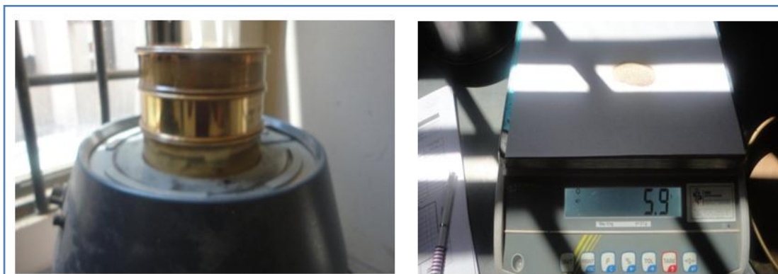
Figura 3.7.- Tamizando y pesando lo que quedo retenido en cada malla
