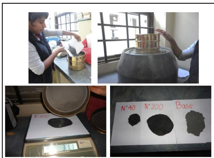
Figura 3.13: Proceso del ensayo de finura para la CCA
