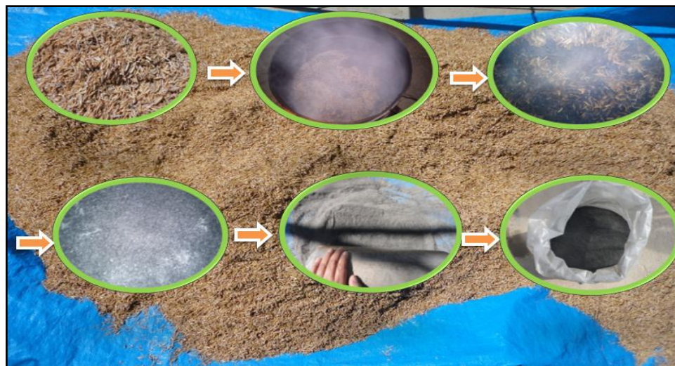
Figura 3.5: Proceso de obtención de ceniza de cascarilla de arroz
