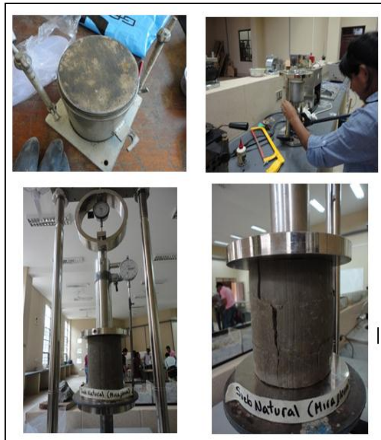
Figura 3.11: Realización del ensayo de compresión Incofinada
