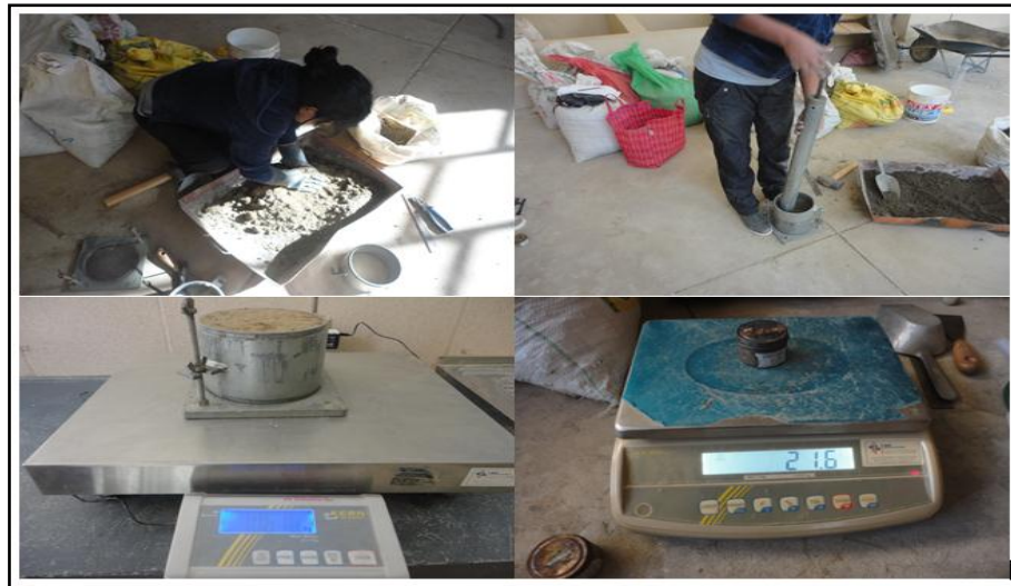
Figura 3.9: Proceso del ensayo de compactación
