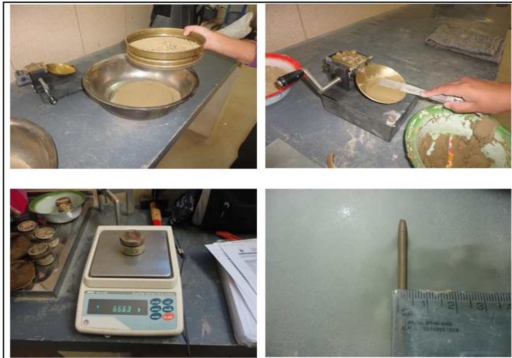
Figura 3.8: Realización del ensayo de límites de Atterberg
