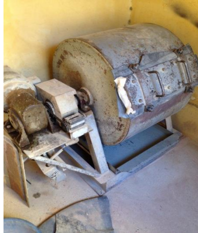
Fotografía 4.8: Máquina de Desgaste de Los Ángeles para el método Cántabro. Fuente: Elaboración propia
