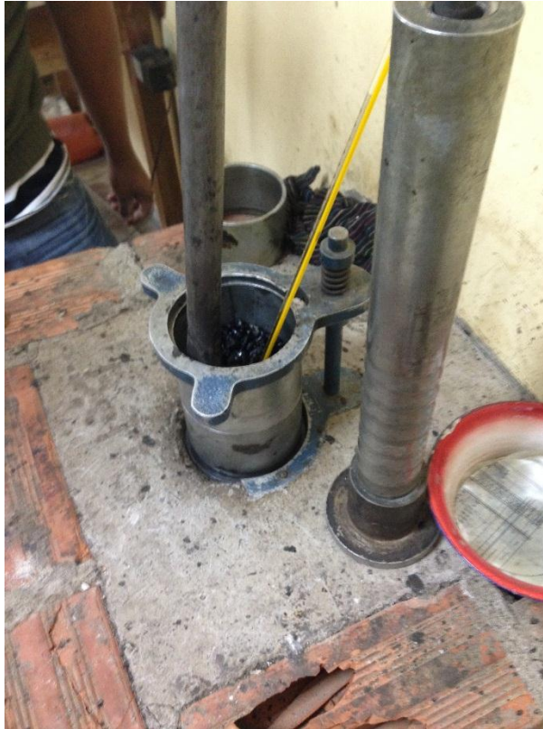
Fotografía 4.6: Proceso de compactación con el martillo de Marshall. Fuente: Elaboración propia
