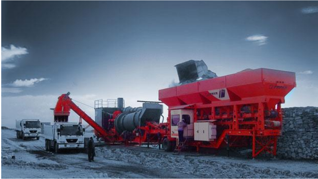
Figura 2.8 Planta Asfáltica de secado a contra flujo. Fuente: http://www.resansil.com/noticias/serie_advanced_ciber.htm
