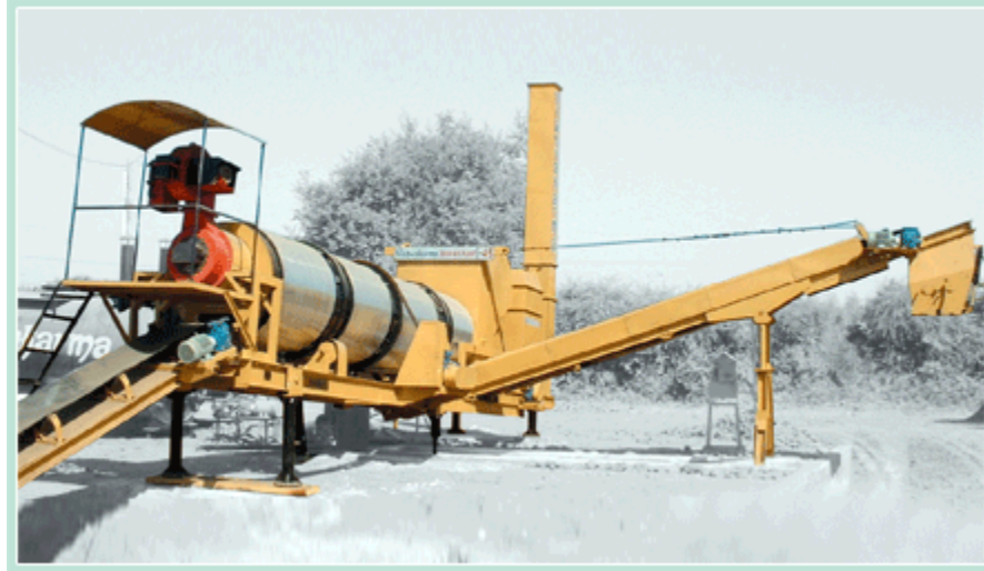
Figura 2.10 Planta asfáltica tipo drum-mix. Fuente: http://vishvakarma.com/Spanich/asphaltdrummix.htm
