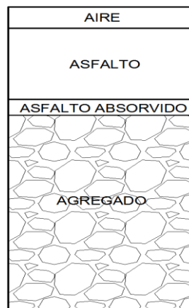
Figura 2.4: Distribución de volúmenes en una mezcla asfáltica. Fuente: Elaboración propia.
