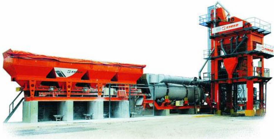
Figura 2.7. Planta asfáltica discontinua. Fuente: https://www.google.com.bo/search?q=plantas+de+asfalto+continuas&espv=2&source
