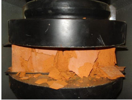
Figura3.3.- Mampuesto después del ensayo a compresión.
