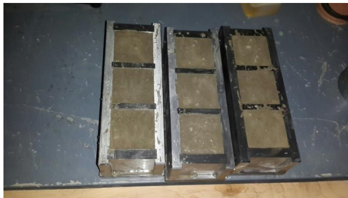
Figura3.5 – Especímenes de mortero para ensayar a compresión.
