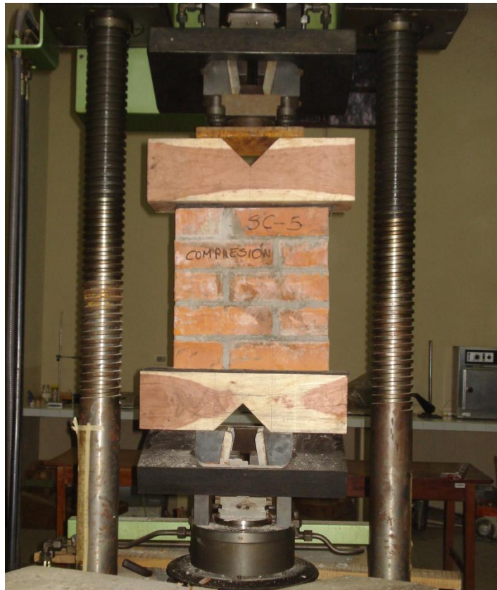
Figura3.8.- Prisma de ensayo a compresión
