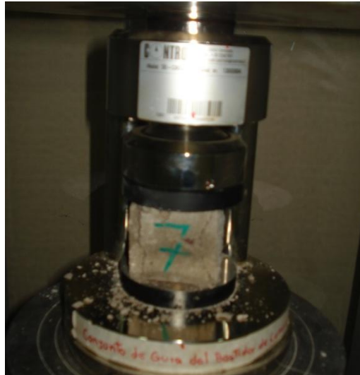
Figura3.6 –Mortero luego de ser ensayado a compresión.
