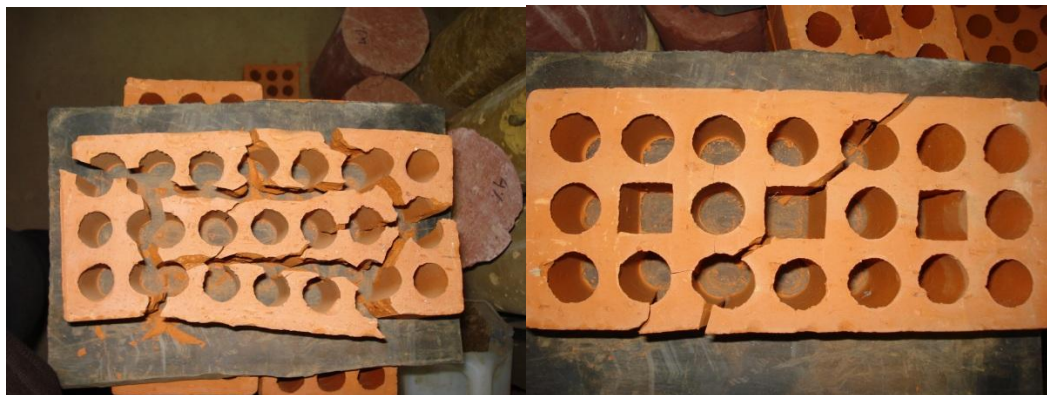
Figura3.4.- Ladrillo después de la ruptura, tipo de falla.
