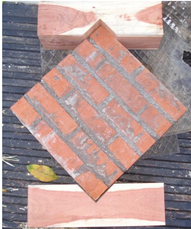
Figura3.9.- Murete de ensayo a corte.
