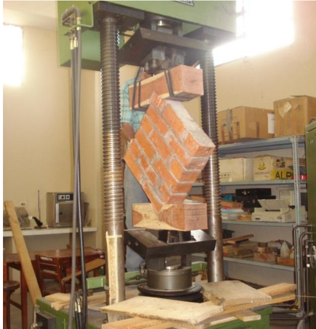
Figura3.10.- Ensayo de resistencia al corte.
