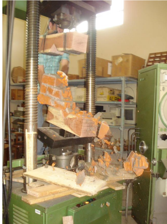
Figura3.11.- Ensayo de resistencia al corte.
