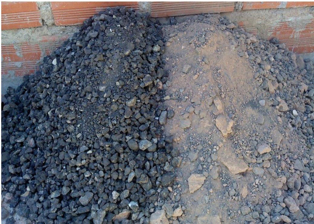
Mezcla de los materiales de capa de rodadura y acopio para capa base
