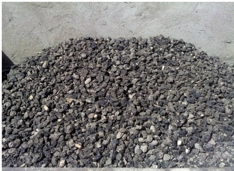
Material triturado de capa de rodadura
