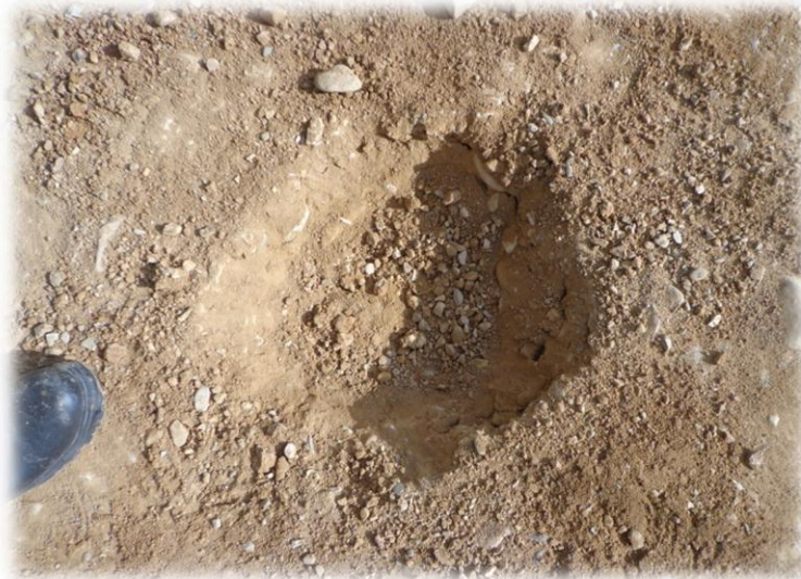
FIGURA N° 18 Toma de muestra para ensayos de laboratorio
