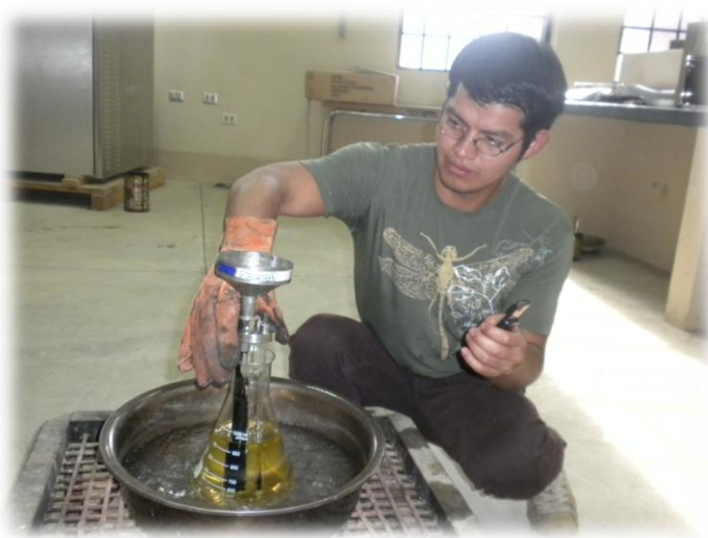
FIGURA N° 35 Líquido asfáltico dentro del viscosímetro
