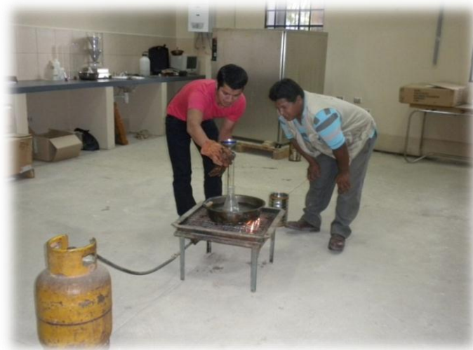
FIGURA N° 33 Viscosímetro capilar en baño María
