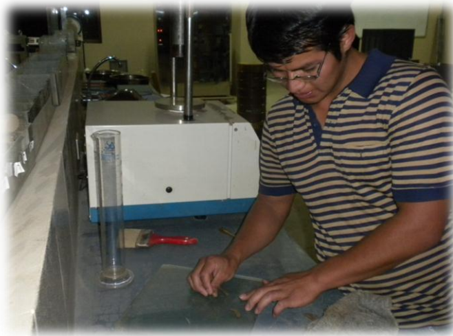
FIGURA N° 22 Ensayo de límite plástico
