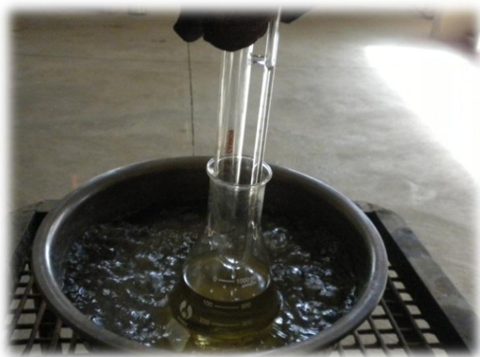
FIGURA N° 34 Viscosímetro a temperatura arriba de los 100°C
