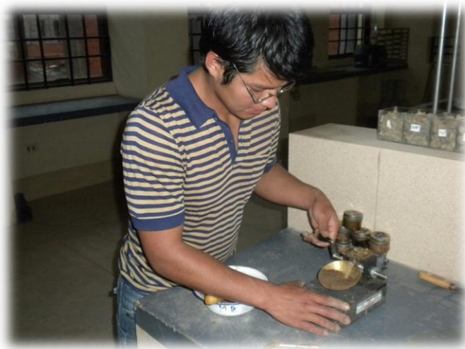
FIGURA N° 21 Ensayo de límite líquido
