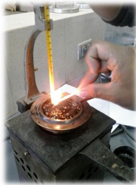
FIGURA N° 42 Punto de ignición del asfalto
