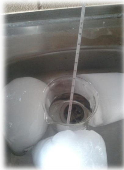
FIGURA N° 43 Agua destilada a 5°C antes del ensayo
