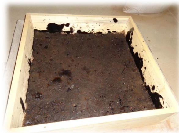
FIGURA N° 60 Riego de asfalto con kerosén para tratamiento superficial
