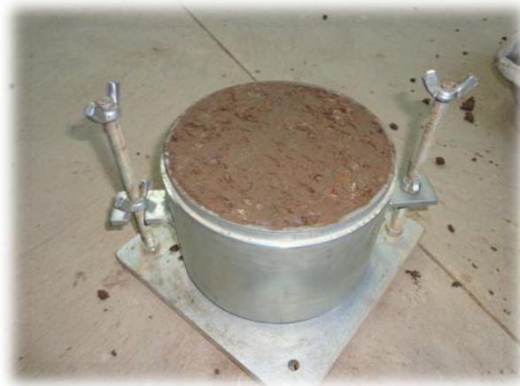
FIGURA N° 24 Molde una vez terminado el proceso de compactación
