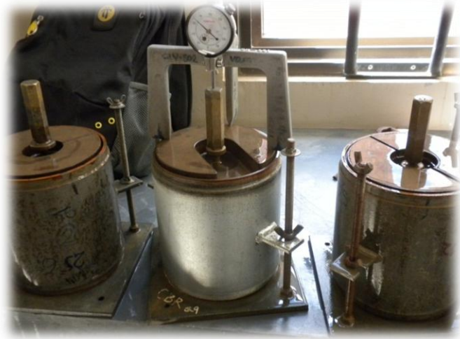
FIGURA N° 26 Lectura de los moldes mediante el extensómetro
