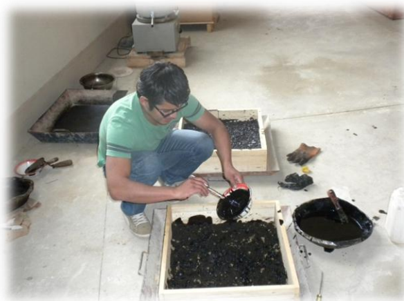
FIGURA N° 62 Riego de asfalto con kerosén para imprimación reforzada
