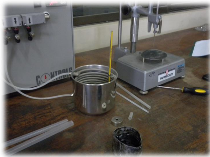
FIGURA N° 37 Tara en reposo con asfalto
