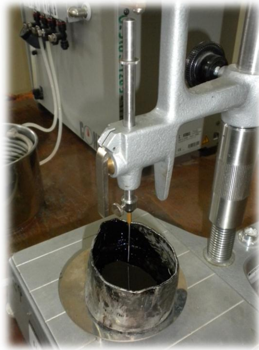
FIGURA N° 38 Penetración de la aguja
