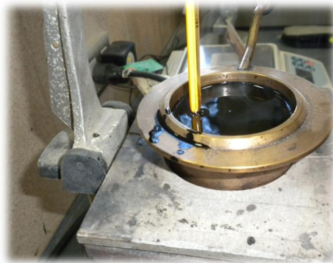
FIGURA N° 40 Cemento asfáltico en la copa
