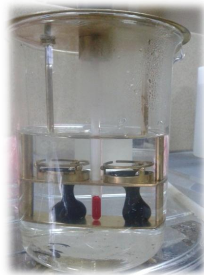
FIGURA N° 44 Temperatura en el momento que el asfalto toca el fondo
