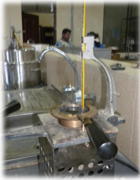
FIGURA N° 41 Calentamiento de cemento asfáltico en la copa
