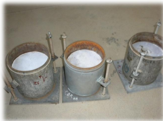
FIGURA N° 25 Moldes una vez compactado
