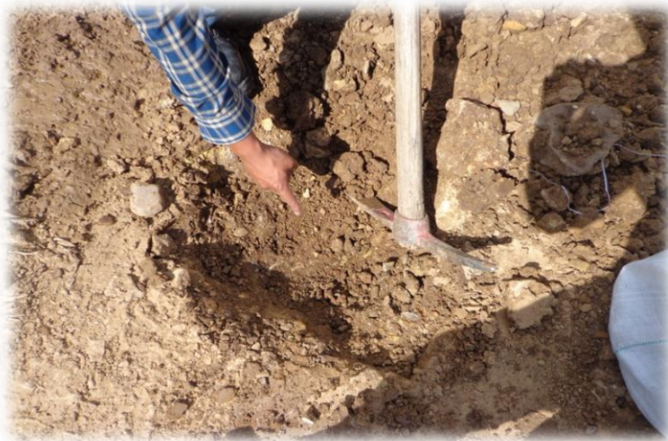
FIGURA N° 12 Toma de muestra para ensayos de laboratorio
