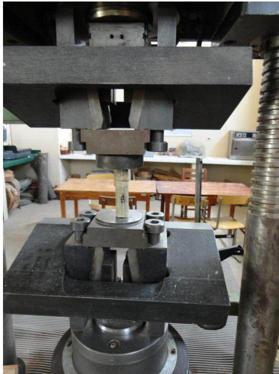
Figura 3.6 Compresión paralela a las fibras con nudo
