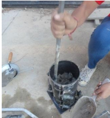
Fotografía N° 7: Colocado del hormigón en los moldes cilíndricos.
