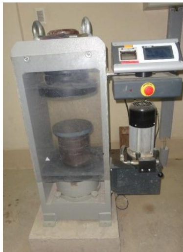
Fotografía N° 9: Equipo utilizado para realizar las rupturas.
