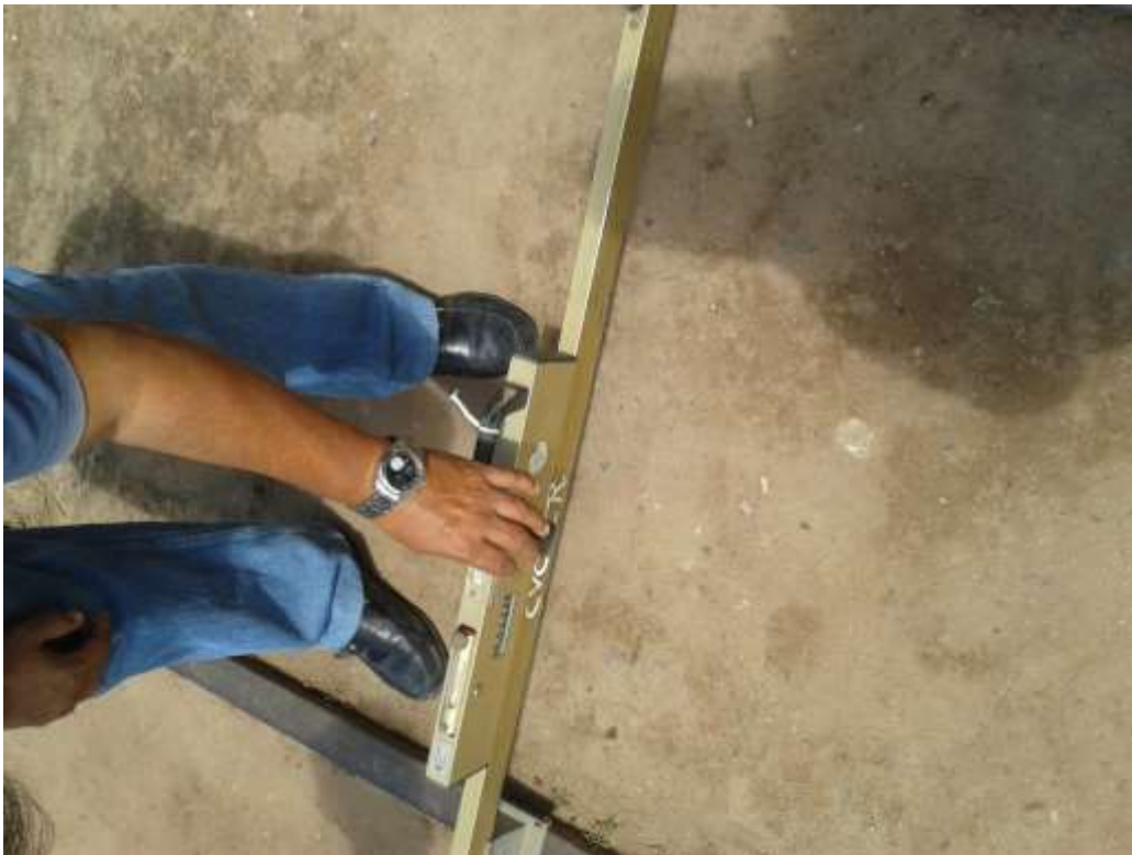
Figura 22. Medición de alabeo con nivel.
