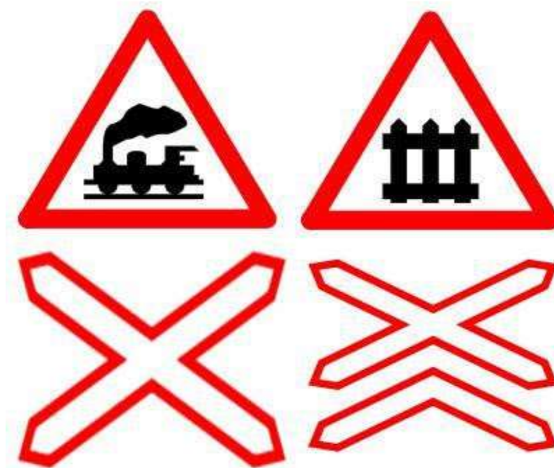
Figura 43. Señalización para cruce.
