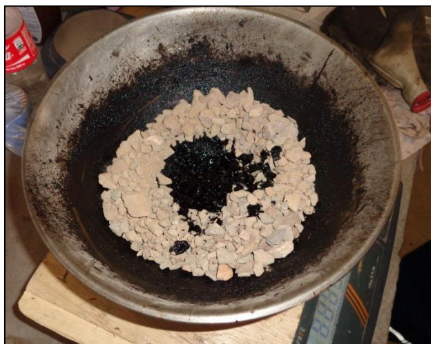
Figura Nº 1-14 Pesaje del contenido de asfalto de la mezcla
