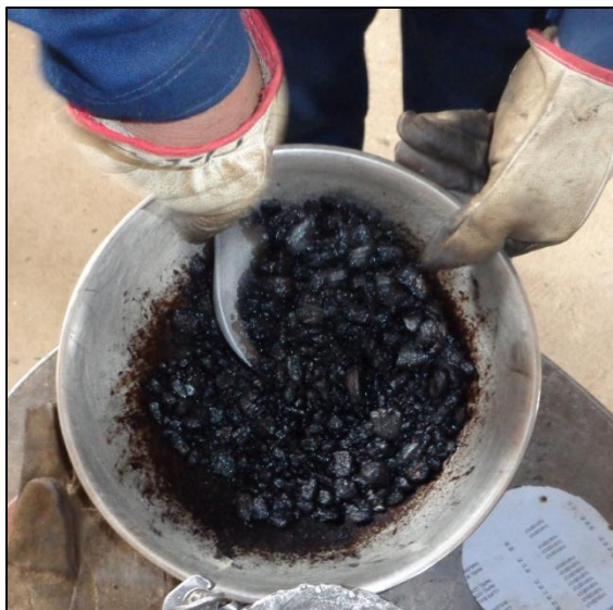
Figura N° 1-15 Mezclado del asfalto con los agregados.
