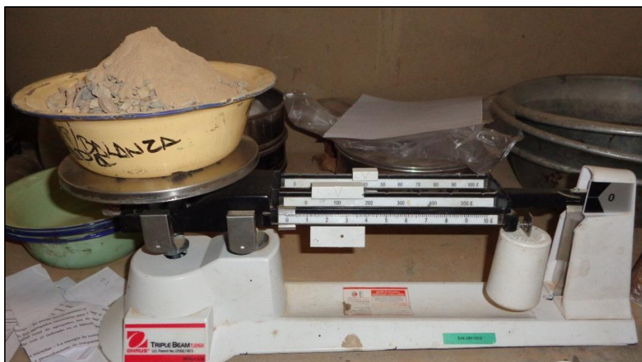
Figura N° 1-12 Pesado del agregado para la mezcla
