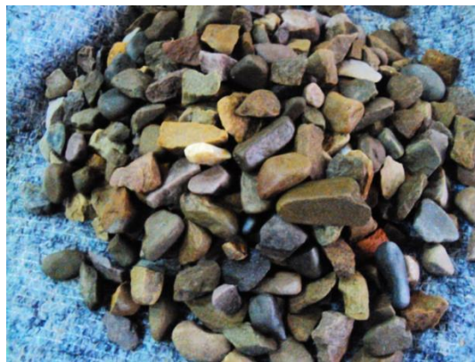
Figura 3.15. Muestras de grava saturada superficialmente seca. (Fuente propia).
