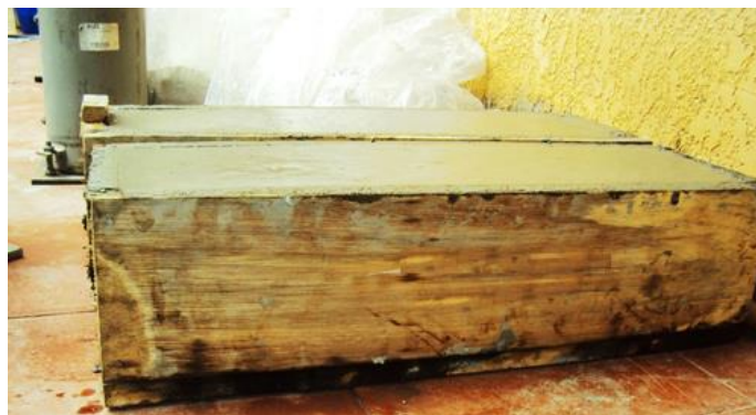
Figura 3.29. Acabado de la superficie de las mezclas en los moldes. (Fuente propia).
