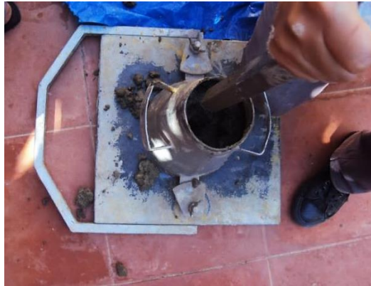
Figura 3.23. Llenado del Cono de Abrams por capas y apisonado de la capa. (Fuente propia).
