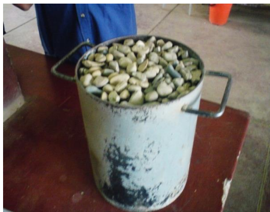
Figura 3.17. Muestra de grava compactada en molde de \frac{1}{2} pie cubico.
