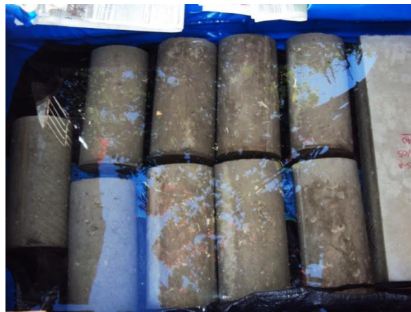
Figura 3.31. Curado de las probetas de hormigón. (Fuente propia).
