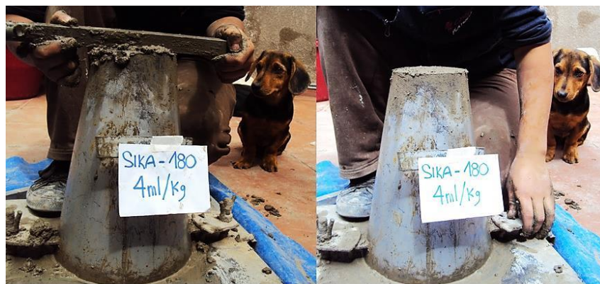
Figura 3.24. Enrase de la parte superior del cono y retiro de exceso de mezcla. (Fuente propia).
