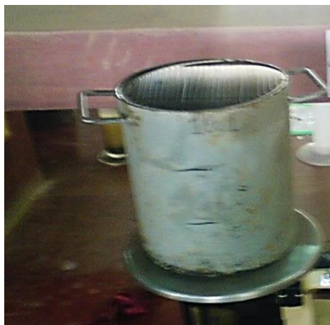
Figura 3.8. Determinación del peso molde cilíndrico de 1/10 pie cubico, (Fuente propia).
