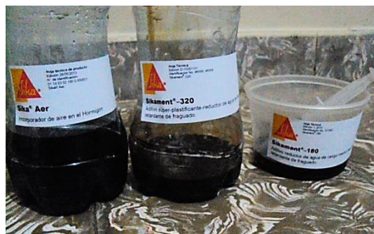
Figura 3.21. Muestra de los tres aditivos utilizados en el diseño de las mezclas. (Fuente propia).
