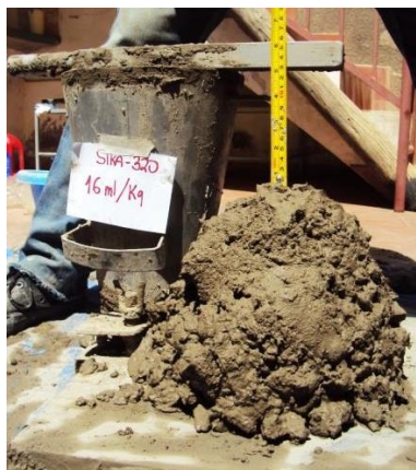
Figura 3.25. Lectura de asentamiento en mezcla con incorporación de aditivo en un 2%. (Fuente propia).
