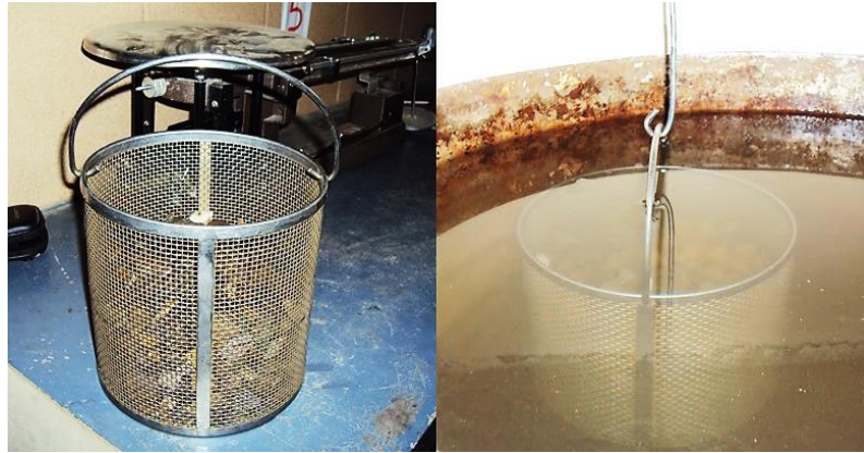
Figura 3.16. Muestra de grava sumergida a una temperatura de 21 °C. (Fuente propia).
