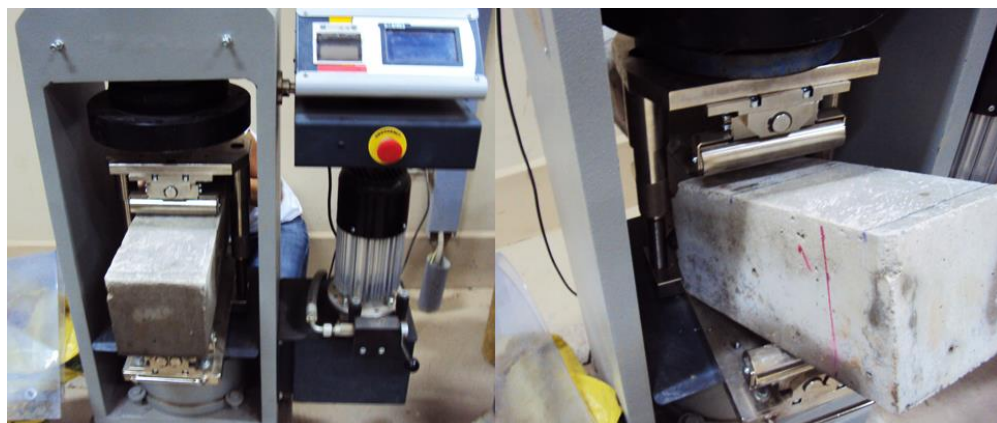
Figura 3.34. Colocación y ruptura de las muestras prismáticas en la máquina de ensayo. (Fuente propia).
