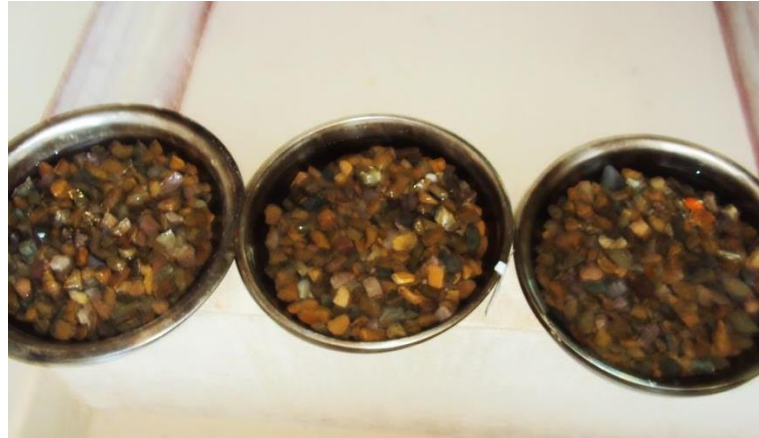
Figura 3.14. Muestras de grava sumergidas en agua durante 24 hrs. (Fuente propia).
