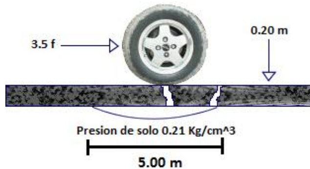
Figura 2.3. Presión sobre la Losa del Pavimento Rígido
