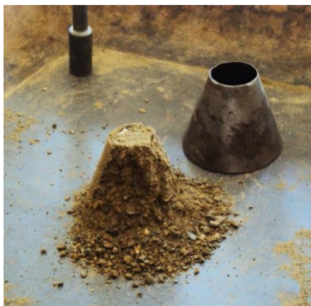
Figura 3.6. Determinación de la condición saturada superficialmente seca, (Fuente propia).
