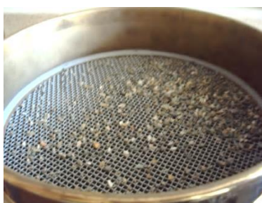
Figura 3.2. Tamizado de la arena por malla N°10. (Fuente Propia).
