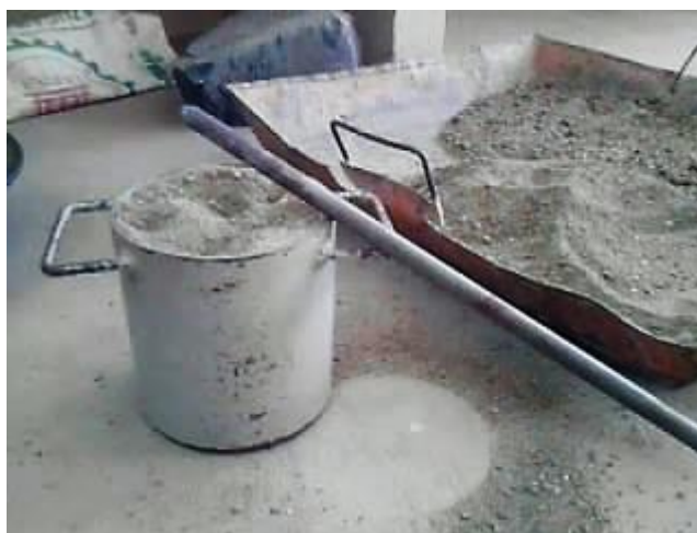
Figura 3.9. Llenado del molde cilíndrico de 1/10 pie cubico con muestra de arena, (Fuente propia).
