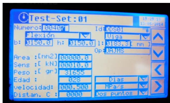
Figura 3.32. Introducción de datos en máquina de ensayo para vigas. (Fuente propia).
