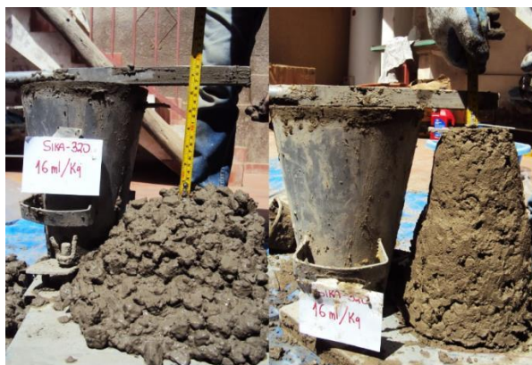
Figura 3.26. Variación del asentamiento en función del tiempo en mezcla con aditivo Sikament 320 a un 2%. (Fuente propia).
