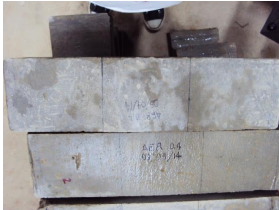
Figura 3.33. Marcado de distancias en probetas prismáticas. (Fuente propia).
