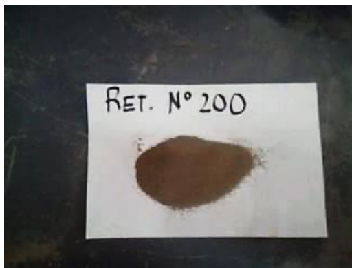
Figura 3.20. Muestra de cemento retenido en malla del Tamiz N°200 (Fuente propia)
