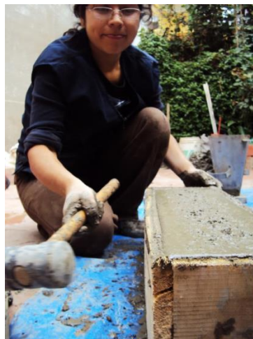
Figura 3.28. Eliminación de vacíos en las esquinas y acomodo de la mezcla en el molde, uso del mazo de goma. (Fuente propia).
