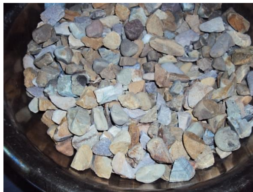
Figura 3.17. Muestra de grava secada en horno a una temperatura de 105 °C. (Fuente propia).
