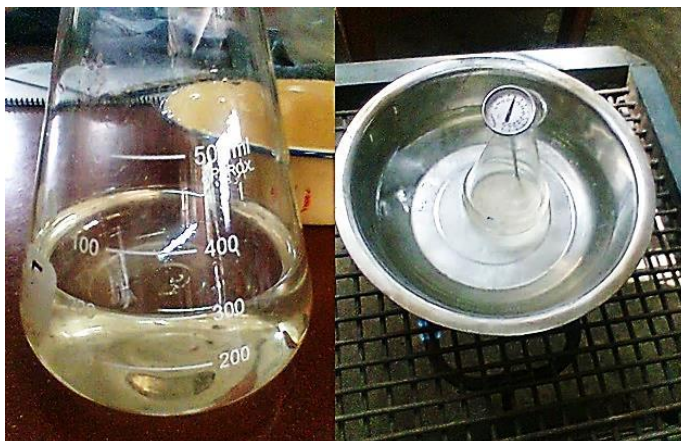
Figura 3.18. Muestra de nafta en el matraz a temperatura constante. (Fuente propia).
