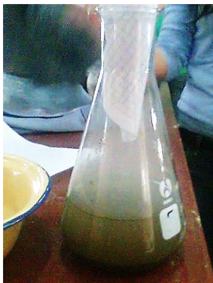
Figura 3.19. Muestra de cemento “El Puente” IP-30 en el matraz con nafta. (Fuente propia).
