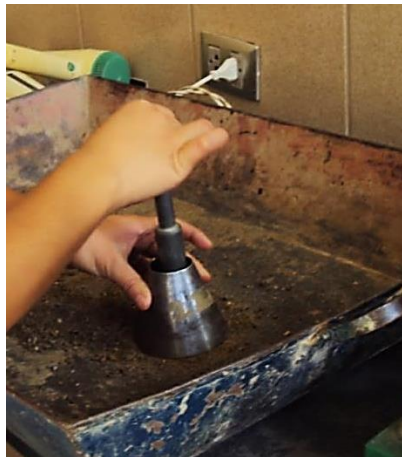
Figura 3.5. Control de la superficie de la arena mediante el uso del molde cónico, (Fuente propia).
