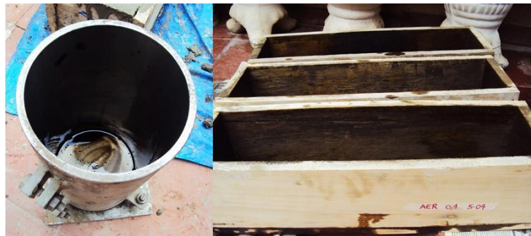
Figura 3.27. Moldes cilindricos y rectangulares engrasados (Fuente propia).
