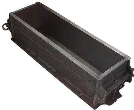
FIGURA 3.19 Moldes de vigas
