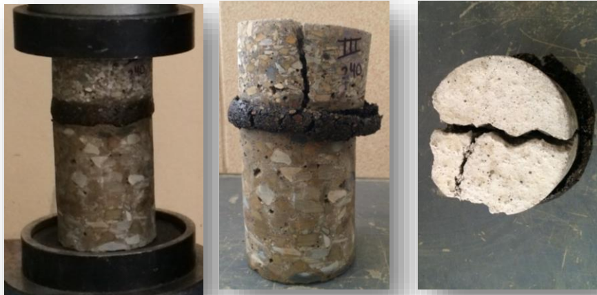
Ruptura de núcleos extraídos en condición no adherida
