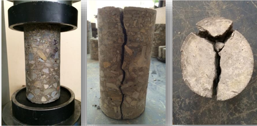
Ruptura de núcleos extraídos en condición adherida
