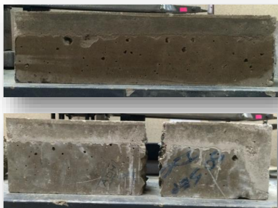
Ruptura de vigas con aplicación de refuerzo en condición adherida.
