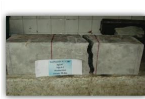
FIGURA 2.26 Ensayo y rotura a flexión de la viga # 2 - 28 días*
