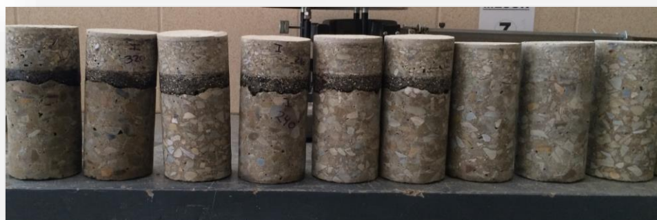
Núcleos extraído de losa de prueba en laboratorio
