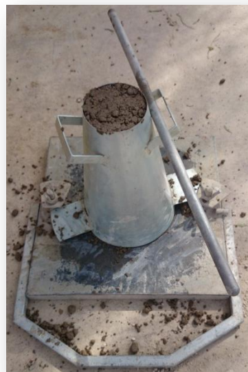
Figura 3.27 Asentamiento – Cono de Abrams
