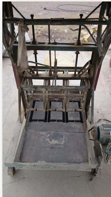
Figura 3.29 Vaciado y Vibrado – Máquina Bloquera
